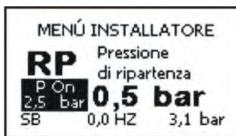
Figura 17: Impostazione della pressione di ripartenza
