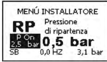
Şekil 17: Yeniden başlatma basıncının ayarlanması
