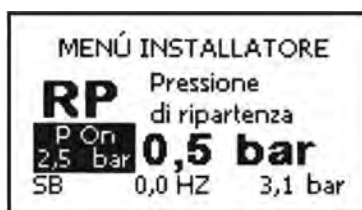
Рисунок 17: Настройка давления нового включения
