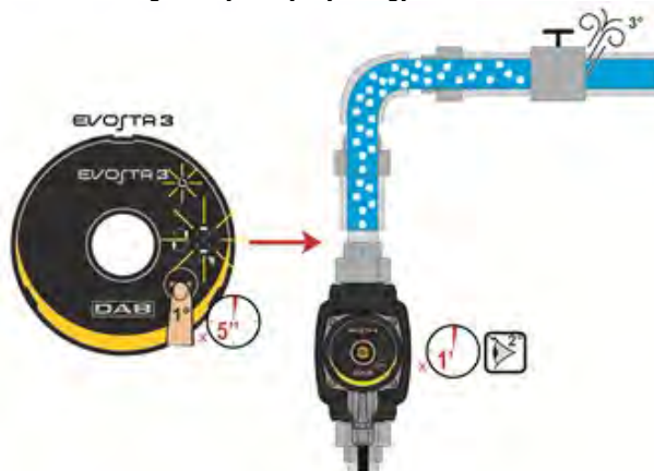
9. ábra: A pumpa automatikus légmentesítése
