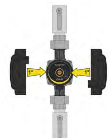
Рисунок 7: Изоляция корпуса насоса
