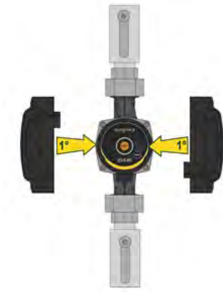
الشكل 7: عزل جسم المضخة
