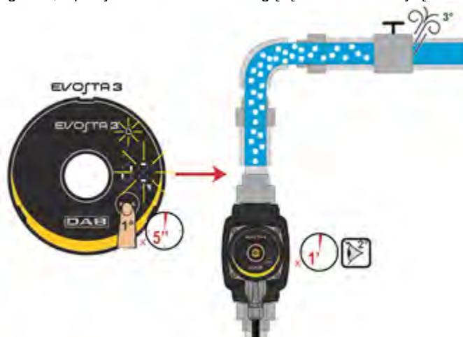
9 pav.: Automatinis oro išleidimas iš siurblio
