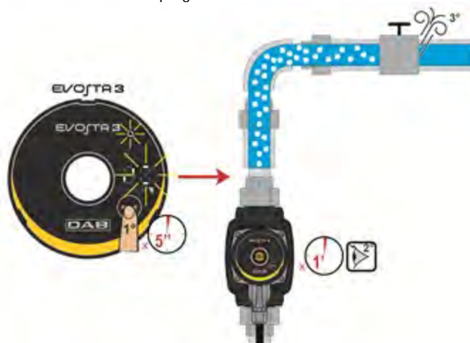
Figura 9: Drenagem automática da bomba
