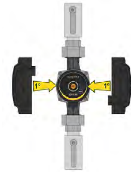
Resim 7: Pompa gövdesinin yalıtımı
