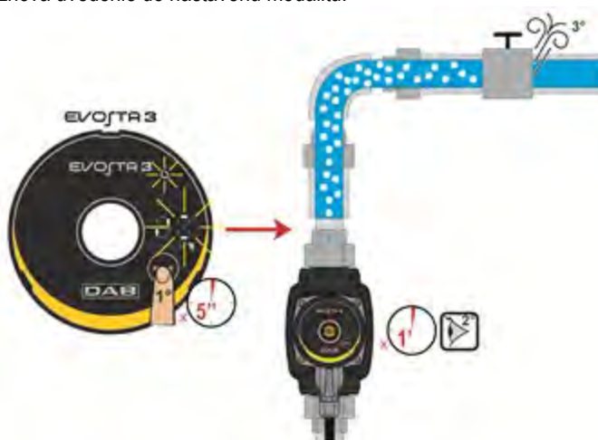
Obrázok 9: Automatické odvzdušnenie čerpadla
