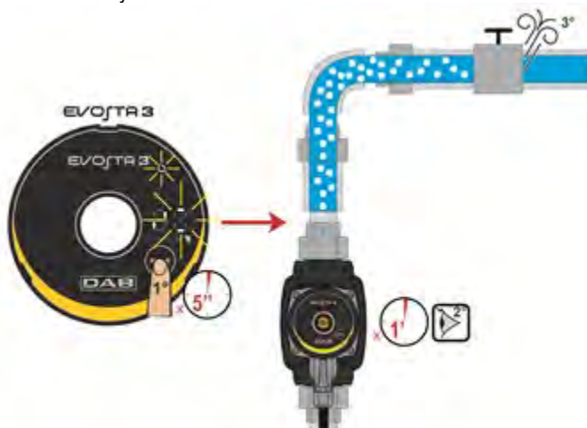
Obrázek 9: Automatické odvzdušnění čerpadla
