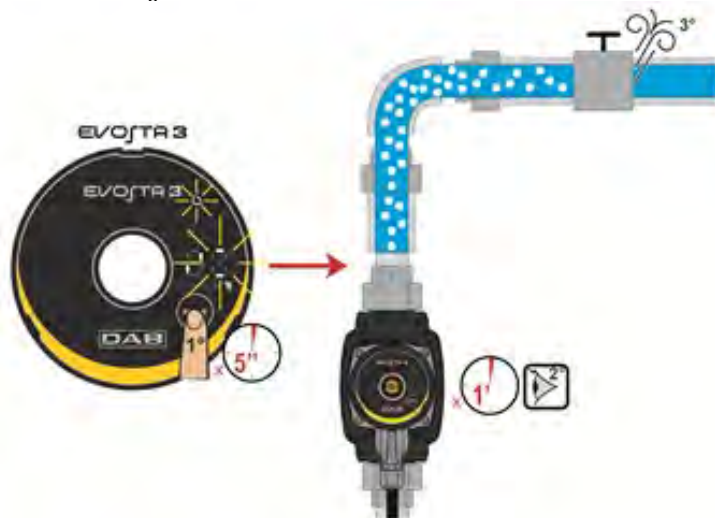
Fig 9: Automatisk avluftning av pumpen
