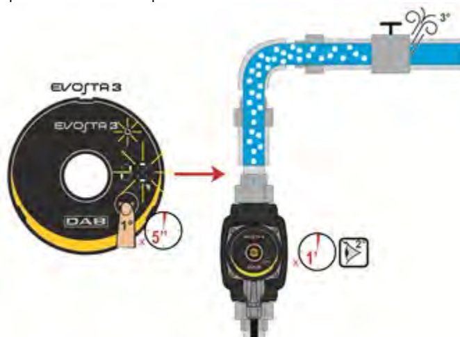
Figura 9: Sfiato automatico della pompa
