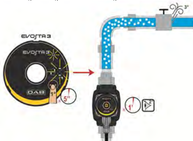
Afbeelding 9: Automatische ontluchting van de pomp
