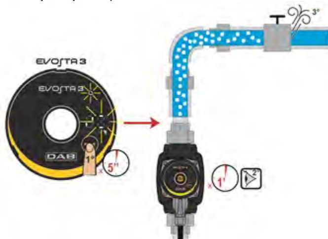
Kuva 9: Pumpun automaattinen ilmaus
