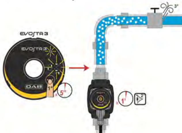
Image 9: Purge automatique de la pompe
