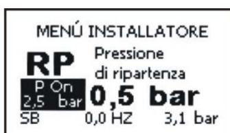
Рисунок 11: Настройка давления нового включения
