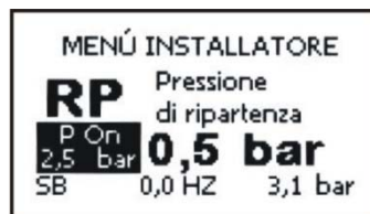
Abbildung 11: Einstellung des Neustartdrucks
