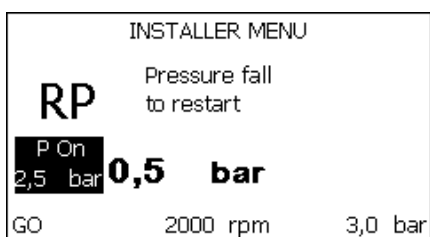
Obr. 18.1: Nastavení tlaku znovuspuštění (2)
