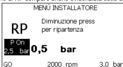
Figura 18.1: Impostazione della pressione di ripartenza (2)
