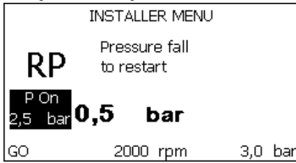
Şekil 18.1: Yeniden başlatma basıncının ayarlanması (2)
