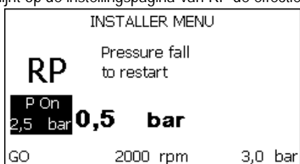
Afb. 18.1: Instelling van de herstartdruk (2)
