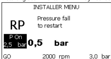
Abbildung 18.1: Einstellung des Neustartdrucks (2)
