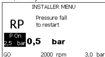
Рисунок 18.1: Настройка давления нового включения (2)
