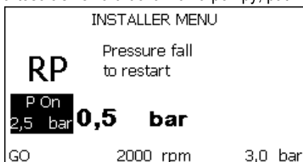
Rysunek 18.1: Ustawianie wartości ciśnienia uruchamiania (2)
