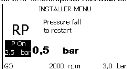
Figura 18.1: Programação da pressão de rearmar (2)
