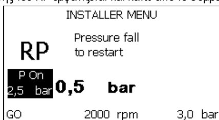
Σχήμα 18.1: Ρύθμιση της πίεσης επανεκκίνησης (2)
