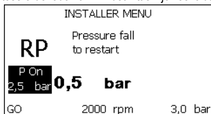
18.1. ábra: az újraindítási nyomás beállítása (2)
