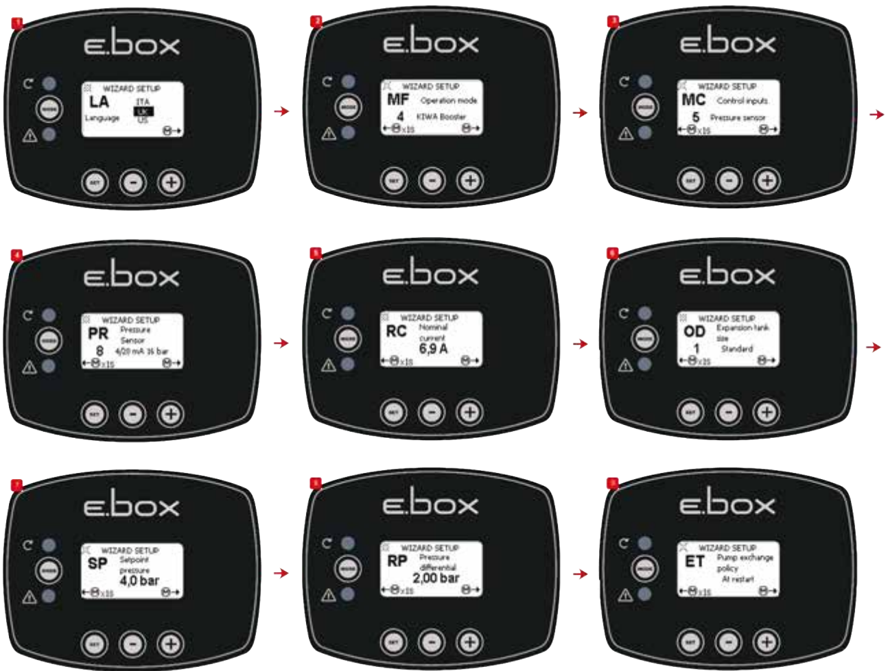
Figura 48: Presurización KIWA con sensor de presión
