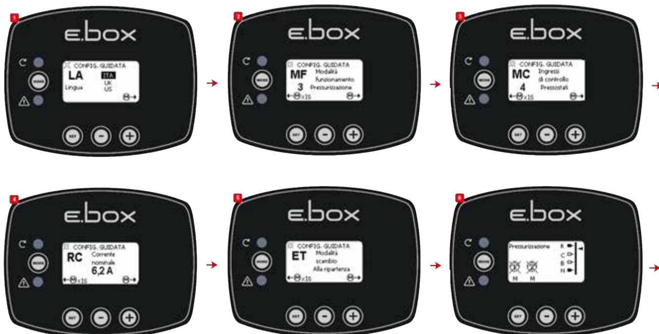
Εικόνα 13: Διαμόρφωση με Πιεσοστάτες
