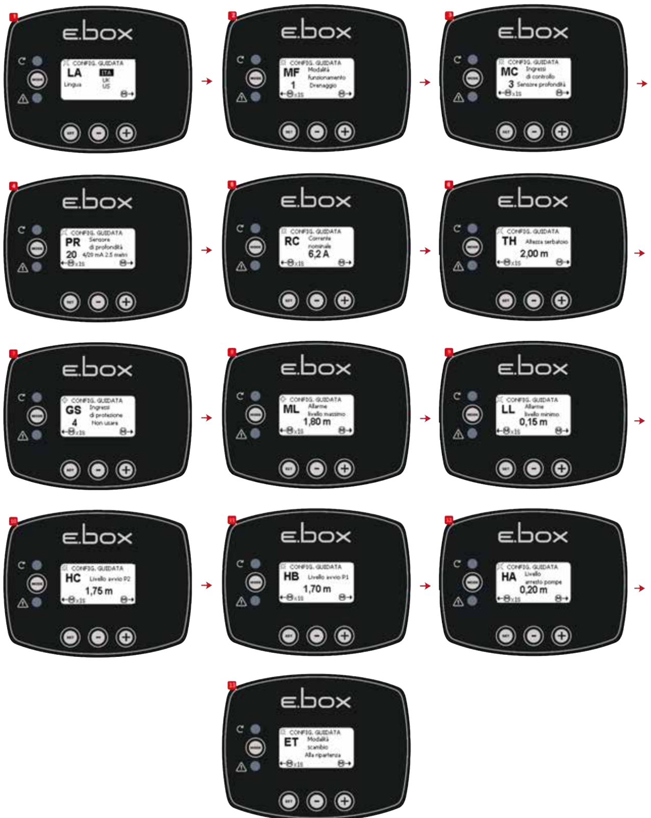
Figura 38: Configurazione con solo sensore di profondità
