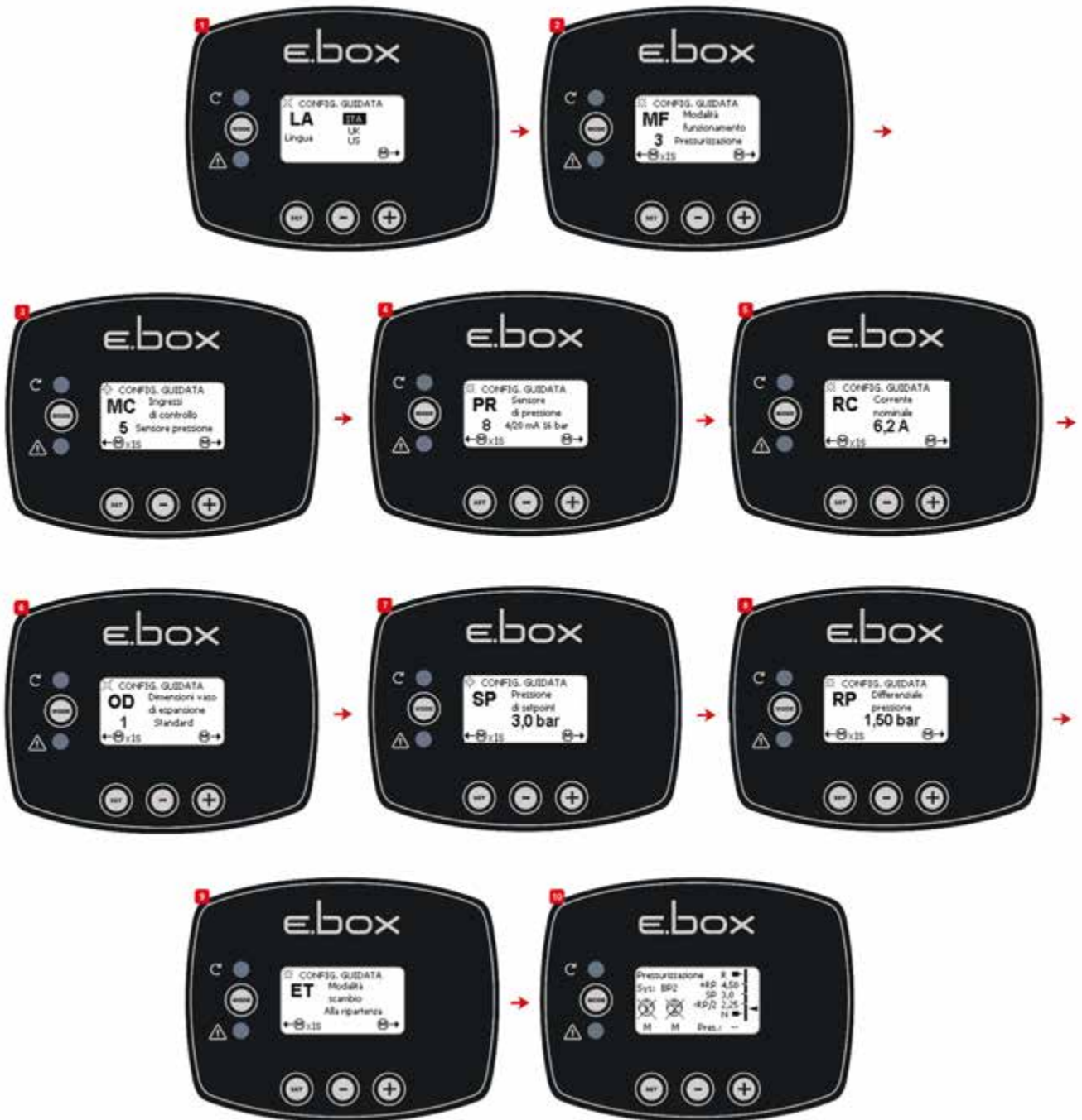
Figura 12: Configurazione con Sensore di pressione
