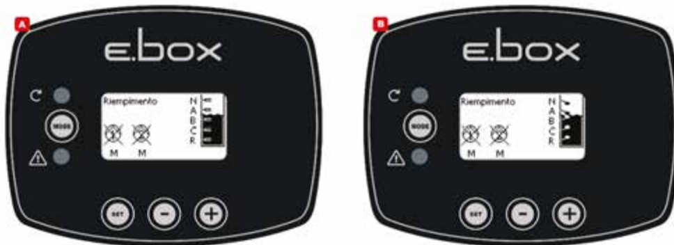
Afbeelding 25: Staat van het systeem in de vulmodus, met controle-ingangen van vlotters of niveauvoelers
