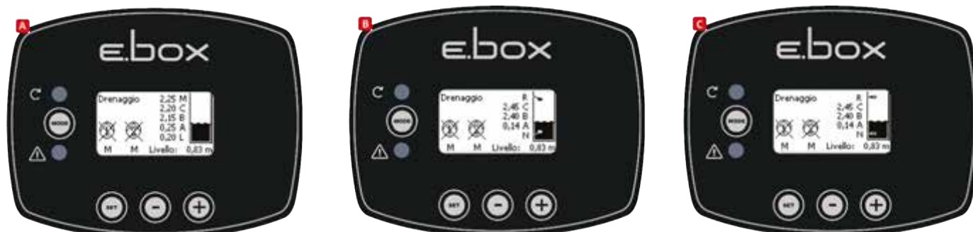
39.ábra: A rendszer státusza a különböző konfigurációkban: A= csak mélység szenzor; B= mélység szenzor és úszókapcsolók; C= mélység szenzor és szint szenzorok
