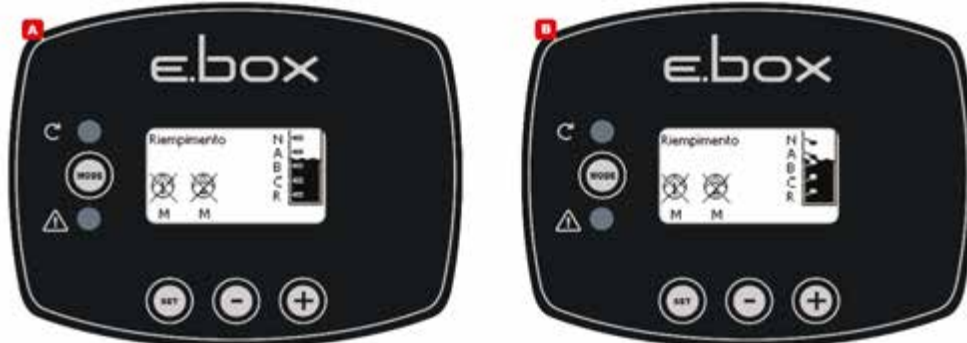
Abbildung 25: Status des Systems in Füllmodus mit Eingängen für die Kontrolle von Schwimmerschaltern oder Standsonden
