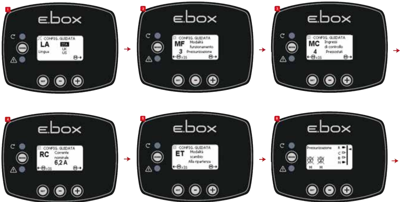
Afbeelding 13: Configuratie met drukschakelaars
