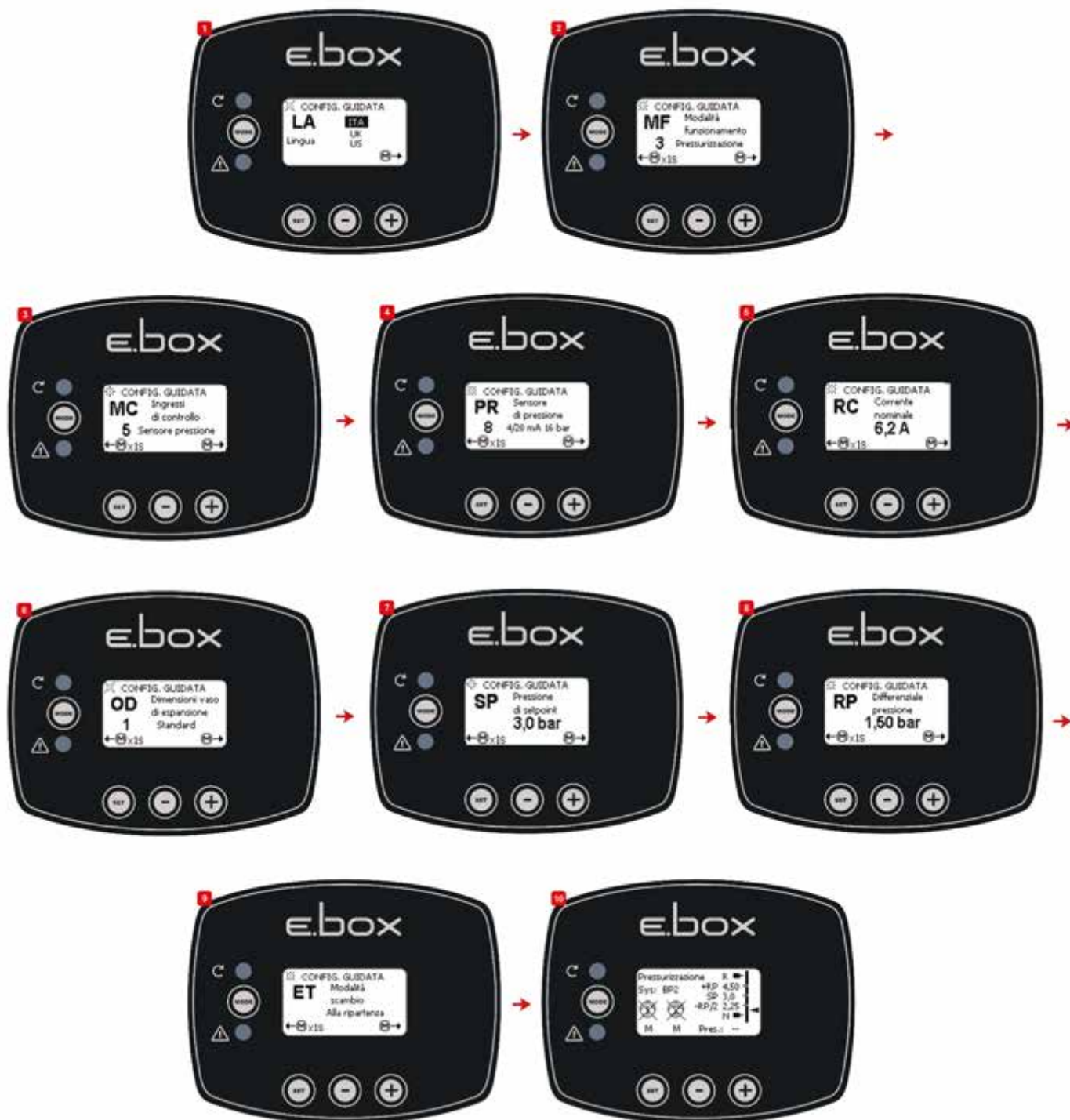
Obrázek 12: Nastavení s tlakovým čidlem
