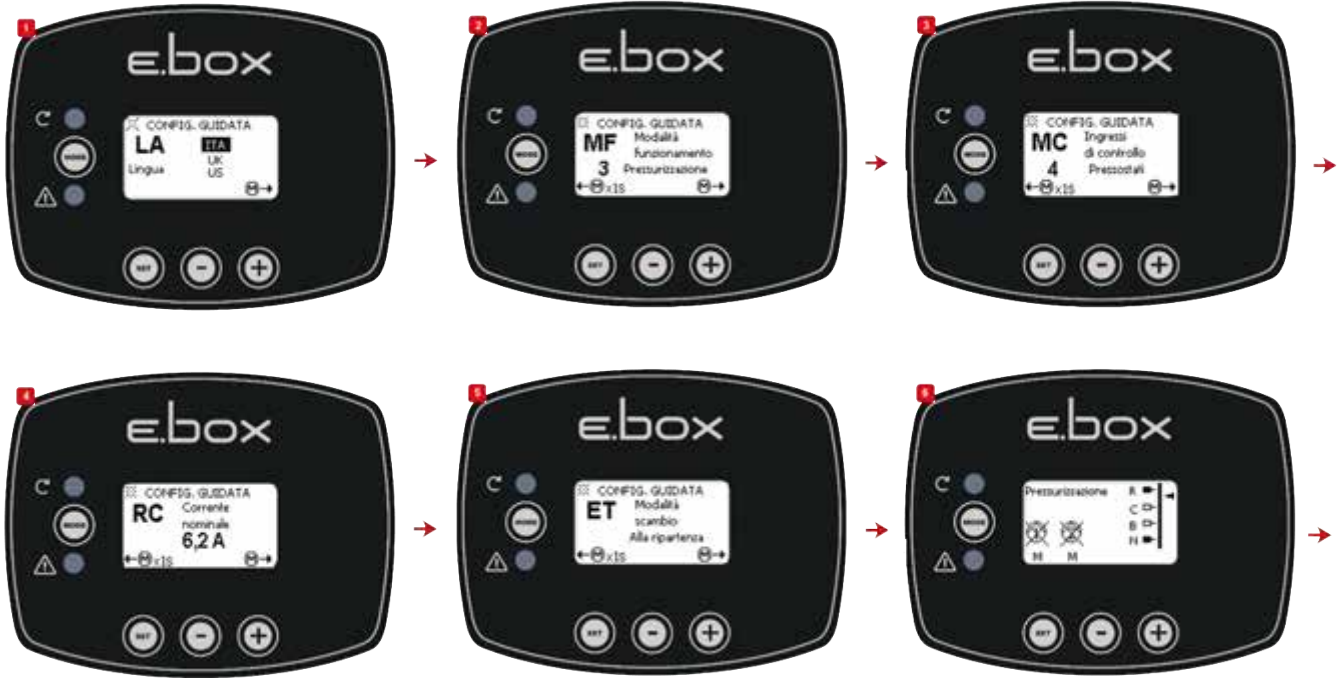
الشكل 13: التهيئة باستخدام مفاتيح الضغط
