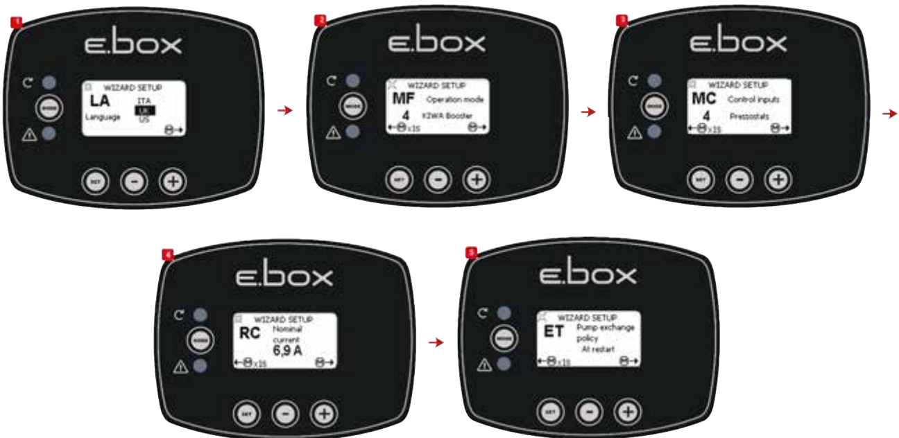
Figure 49 : Configuration KIWA avec des pressostats
