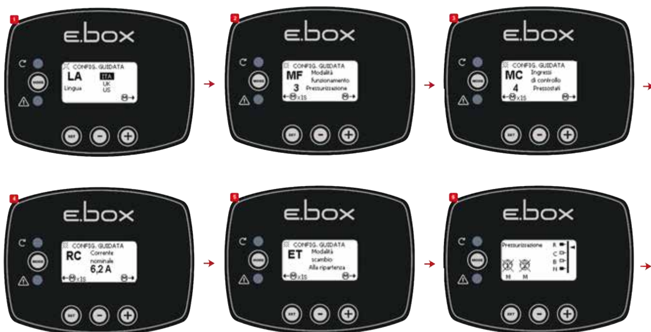
Obrázek 13: Nastavení s tlakovými spínači
