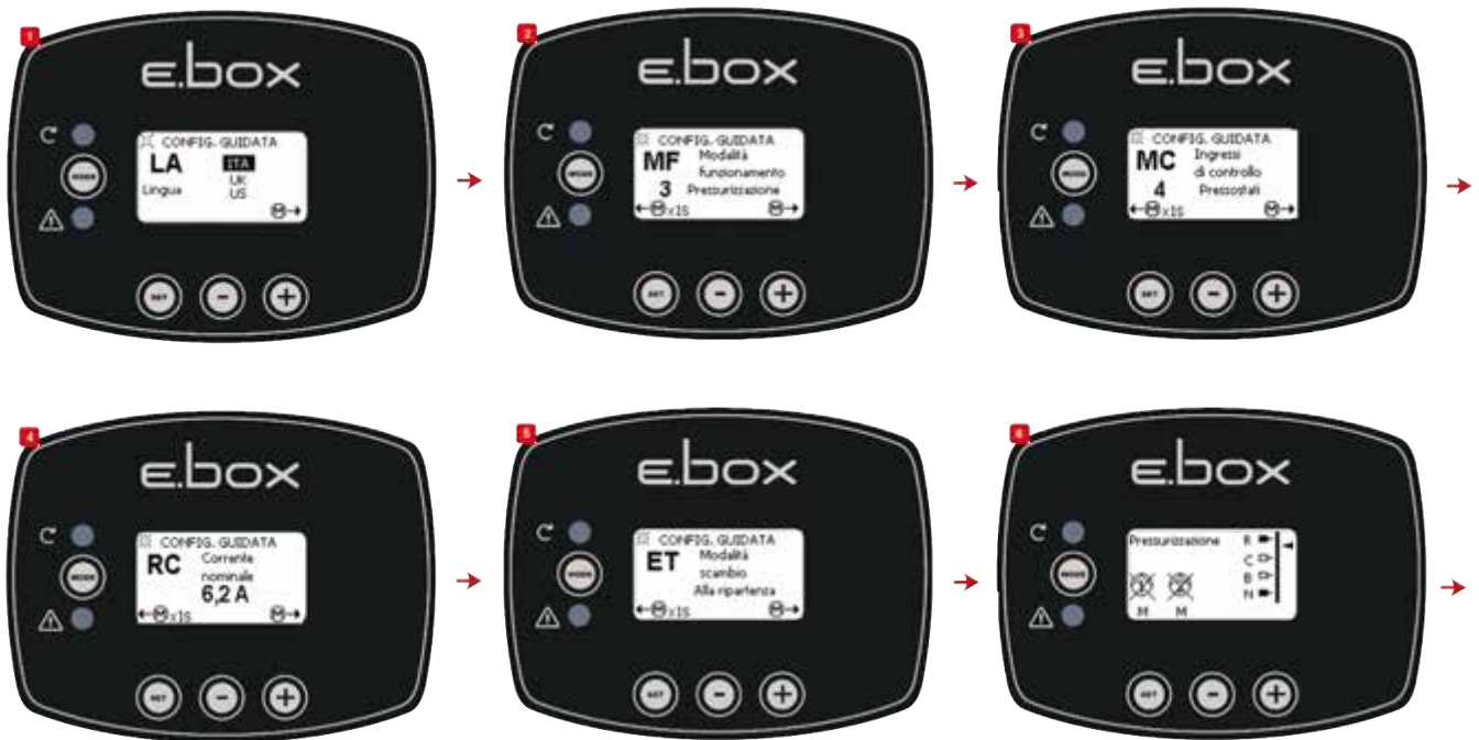
Abbildung 13: Konfiguration mit Druckwächtern
