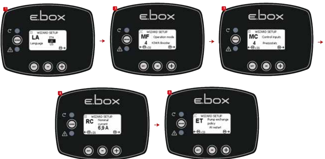
Figura 49: Configuración Kiwa con presostatos
