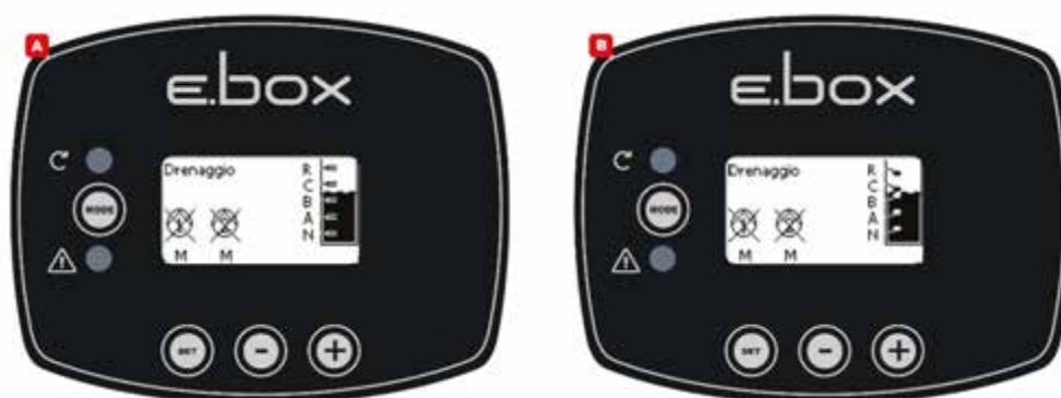
Εικόνα 37: Κατάσταση του συστήματος στην αποστράγγιση, A με αισθητήρια στάθμης, B με πλωτήρες
