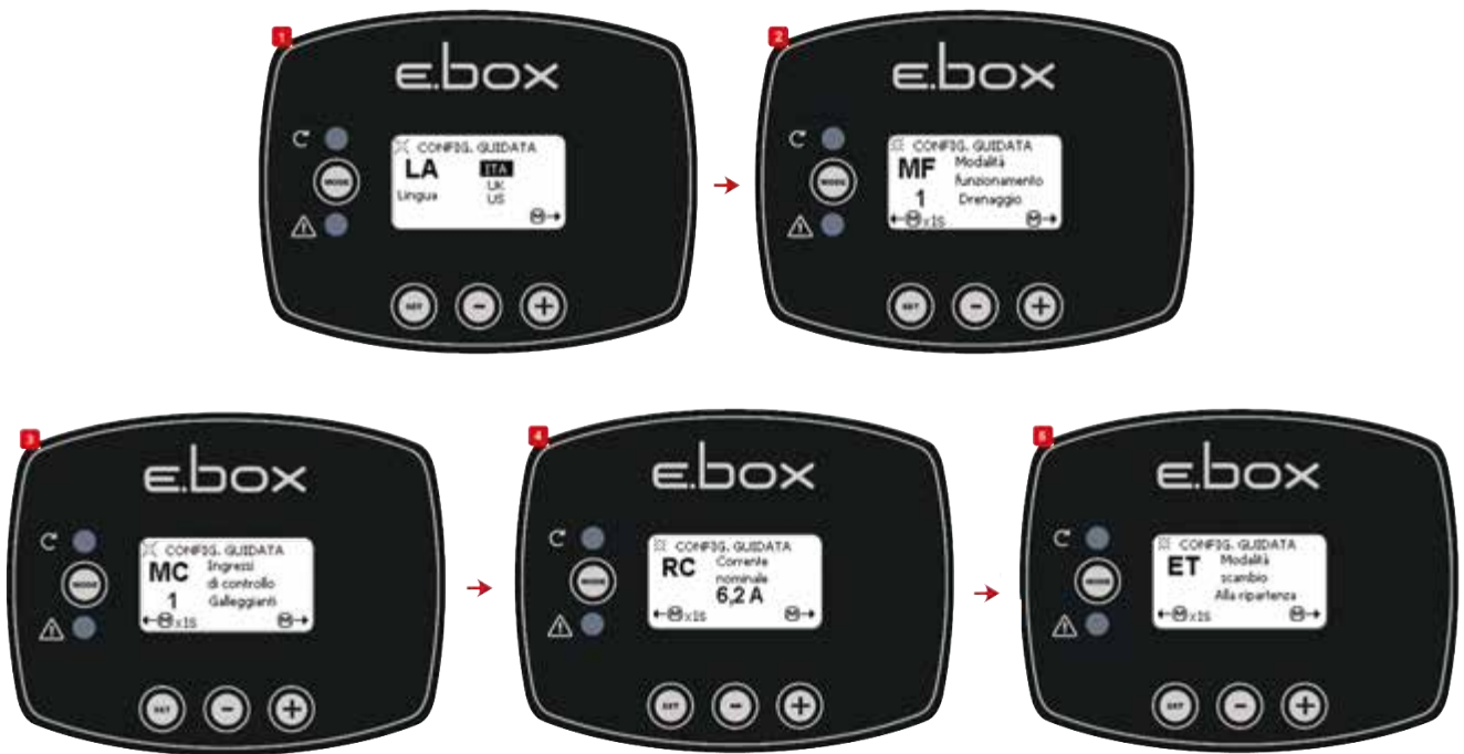
Схема 36: Конфигурация Дренажа поплавков или зондов уровня
