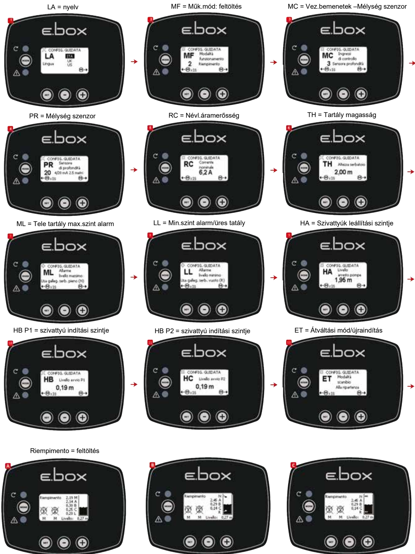
26.ábra: A rendszer státusza csak mélység szenzort használva; B= mélység szenzor és úszókapszolók; C= mélység szenzor és szint szenzorok
