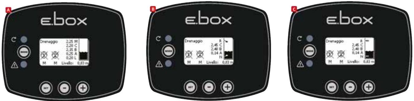
Kuva 39. Järjestelmän tila määrittämisillä: A vain syvyysanturi, B syvyysanturi ja uimurit, C syvyysanturi ja tasoanturit
