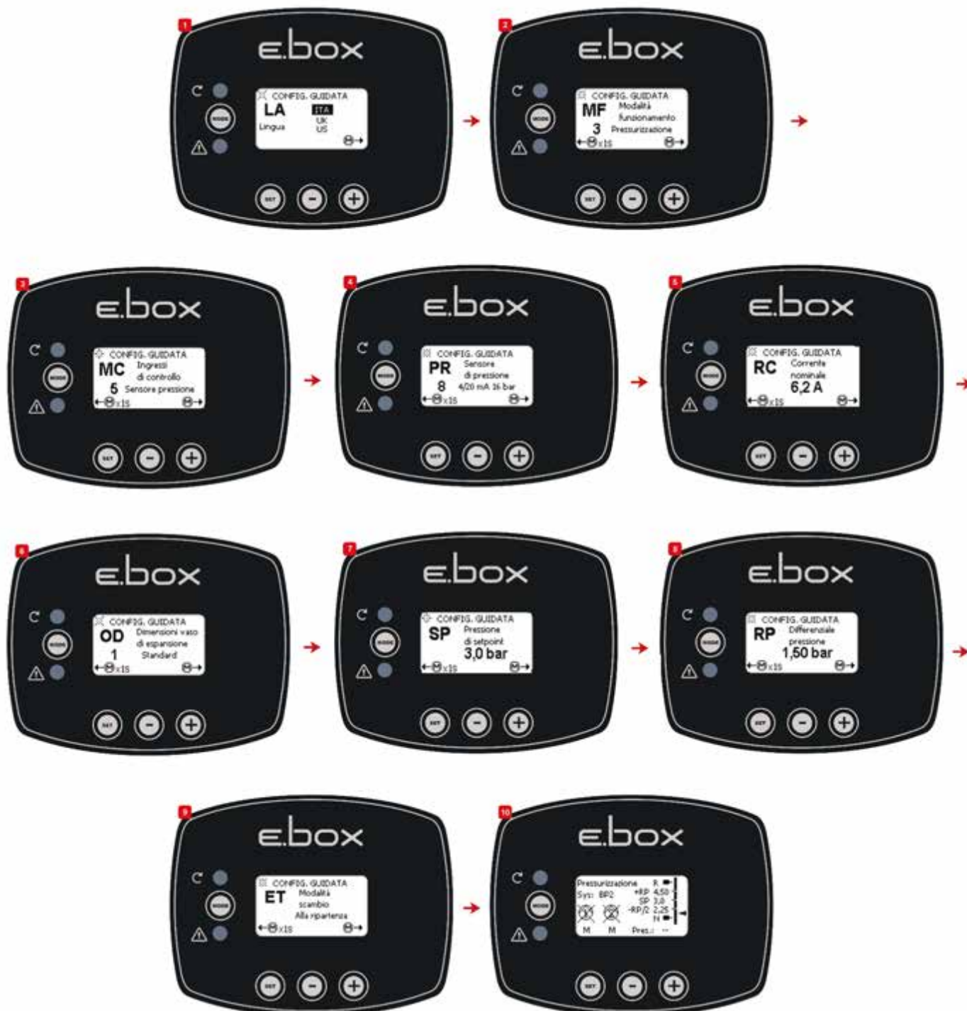
Rysunek 12: Ustawianie za pomocą czujnika ciśnienia
