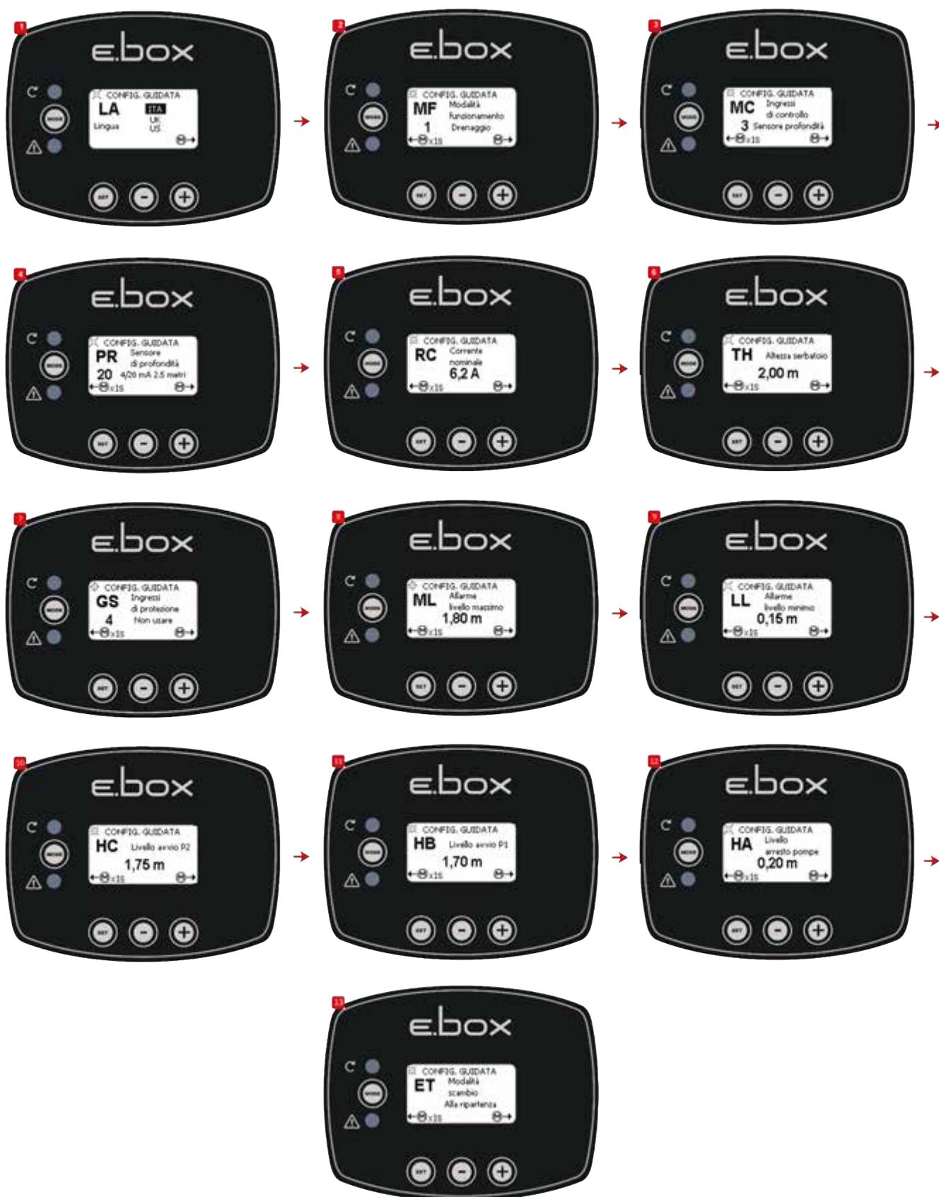
Figura 38: Configurare doar cu senzor de presiune
