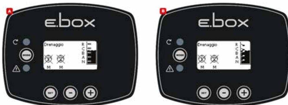
Kuva 37. Järjestelmän tila tyhjennyksessä, A tasoantureilla, B uimureilla
