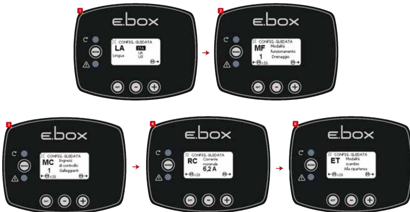
Εικόνα 36: Διαμόρφωση πλωτήρων ή αισθητηρίων στάθμης στην αποστράγγιση
