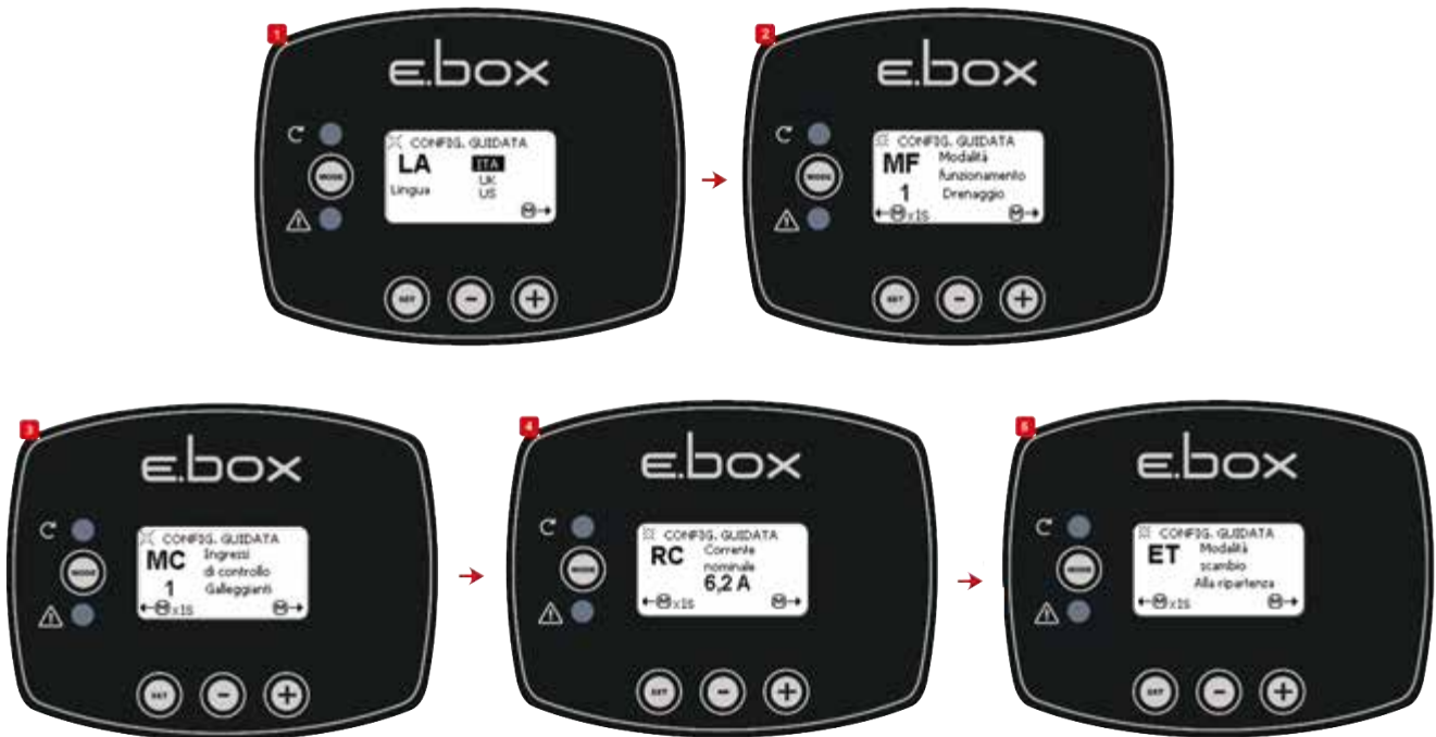
Afbeelding 36: Configuratie Ontwatering met vlotters of niveauvoelers
