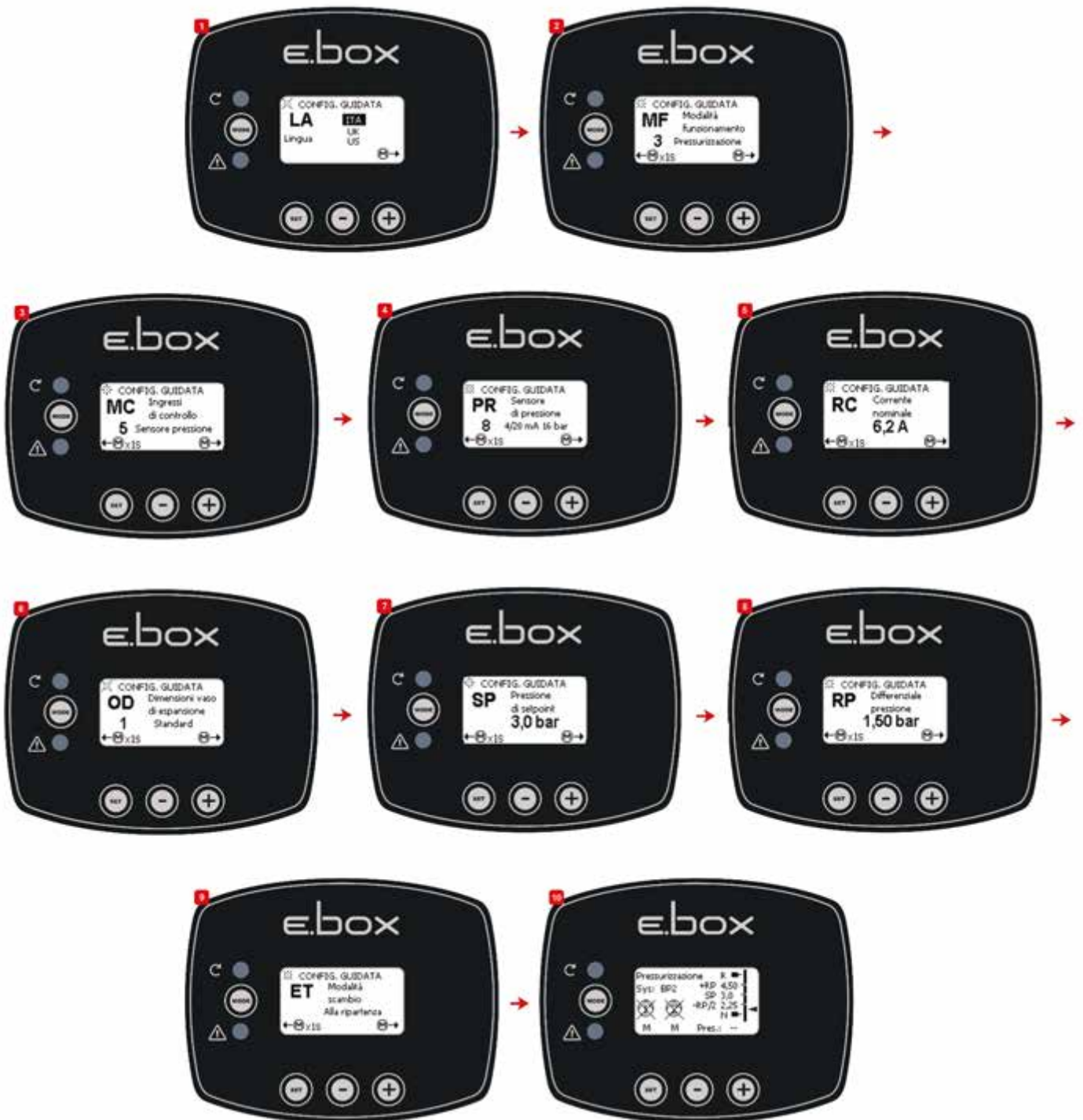
Схема 12: Конфигурация с датчиком давления
