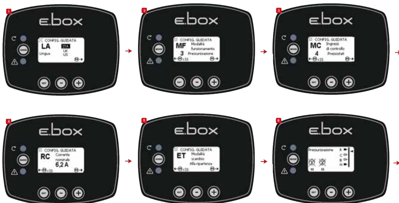
Схема 13: Конфігурація з реле тиску
