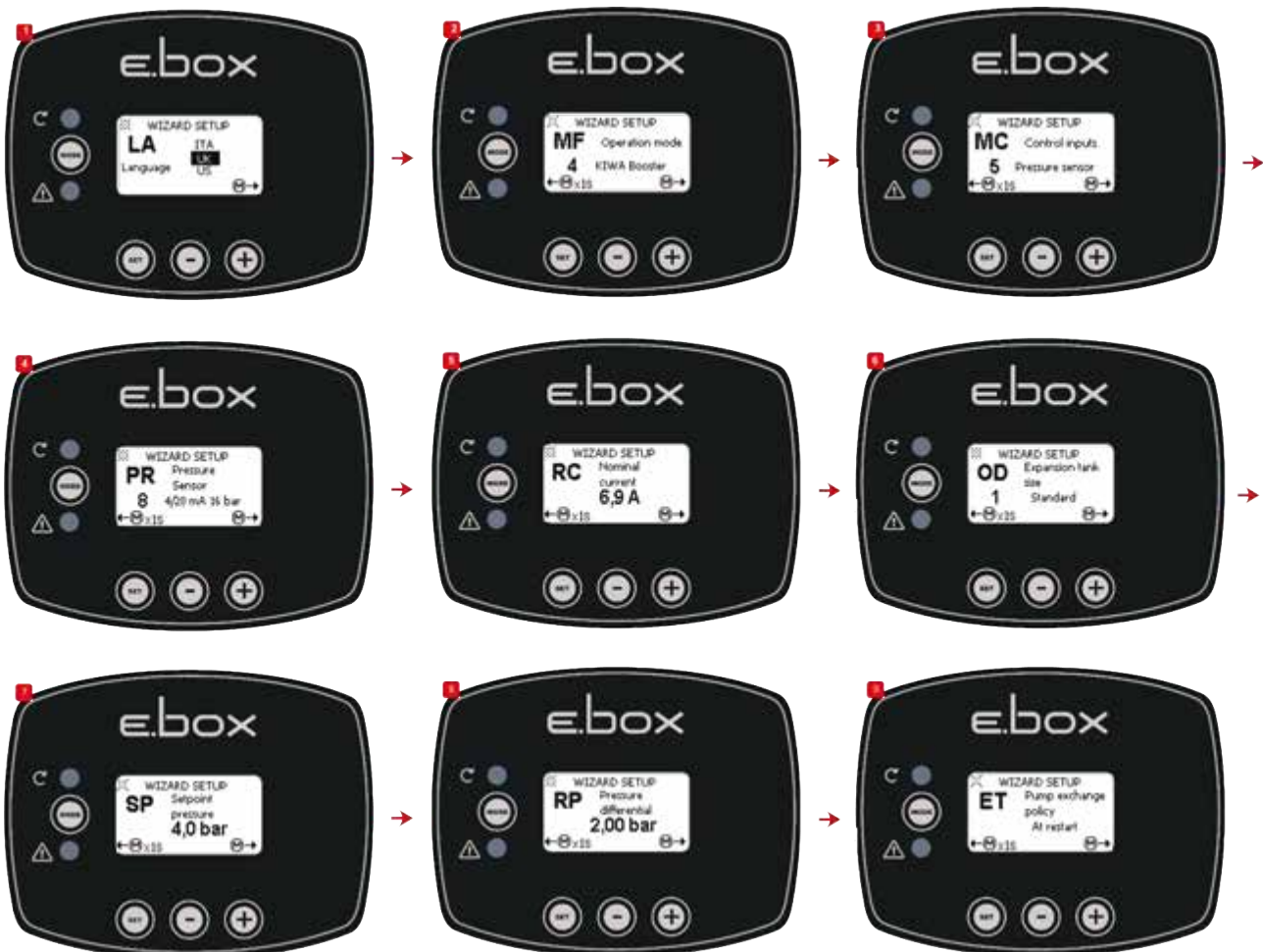
Abbildung 48: KIWA Druckerhöhung mit Drucksensor
