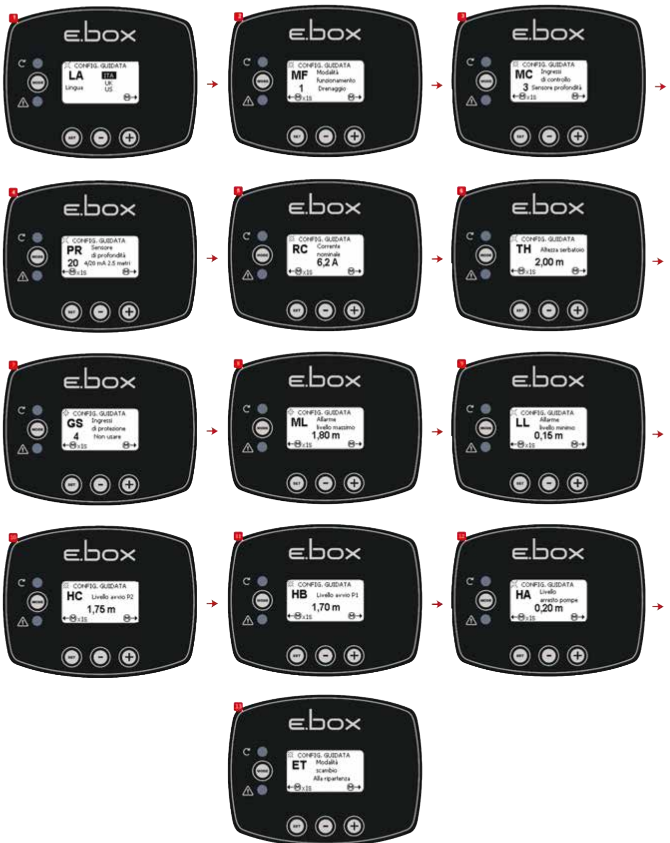
Afbeelding 38: Configuratie met alleen dieptesensor
