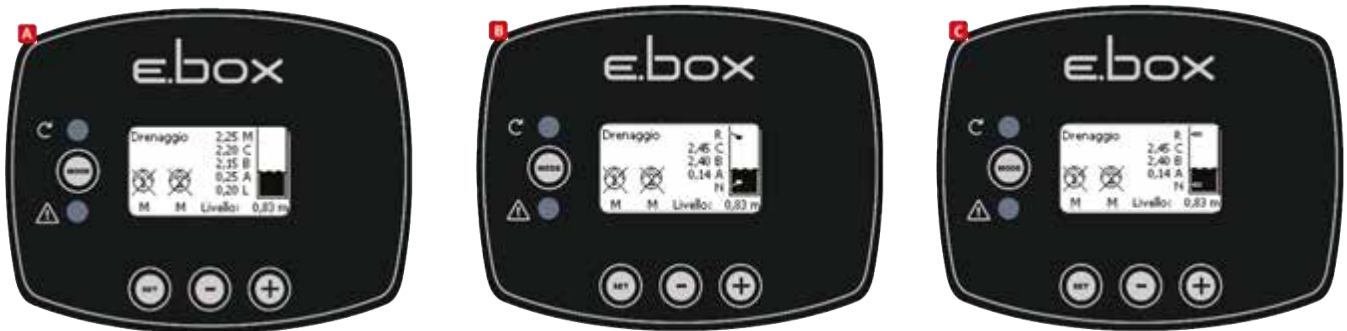
Abbildung 39: Status des Systems in den Konfigurationen: A nur Tiefensensor, B: Tiefensensor und Schwimmerschalter, C Tiefensensor und Standsonden
