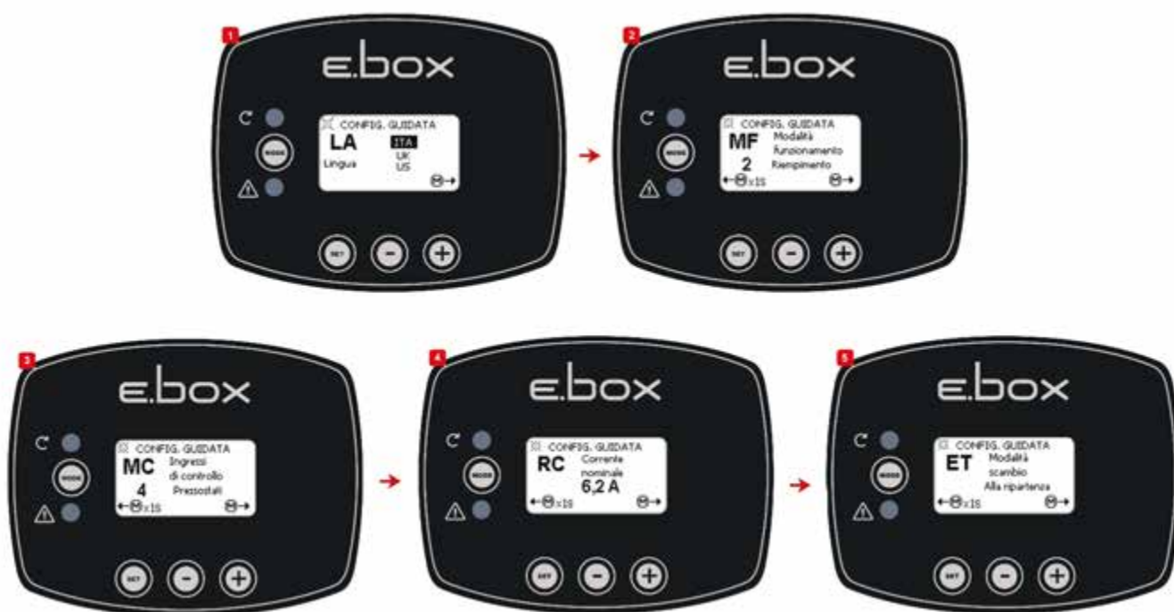
Rysunek 24: Konfiguracja napełniania za pomocą pływaków lub sond poziomu
