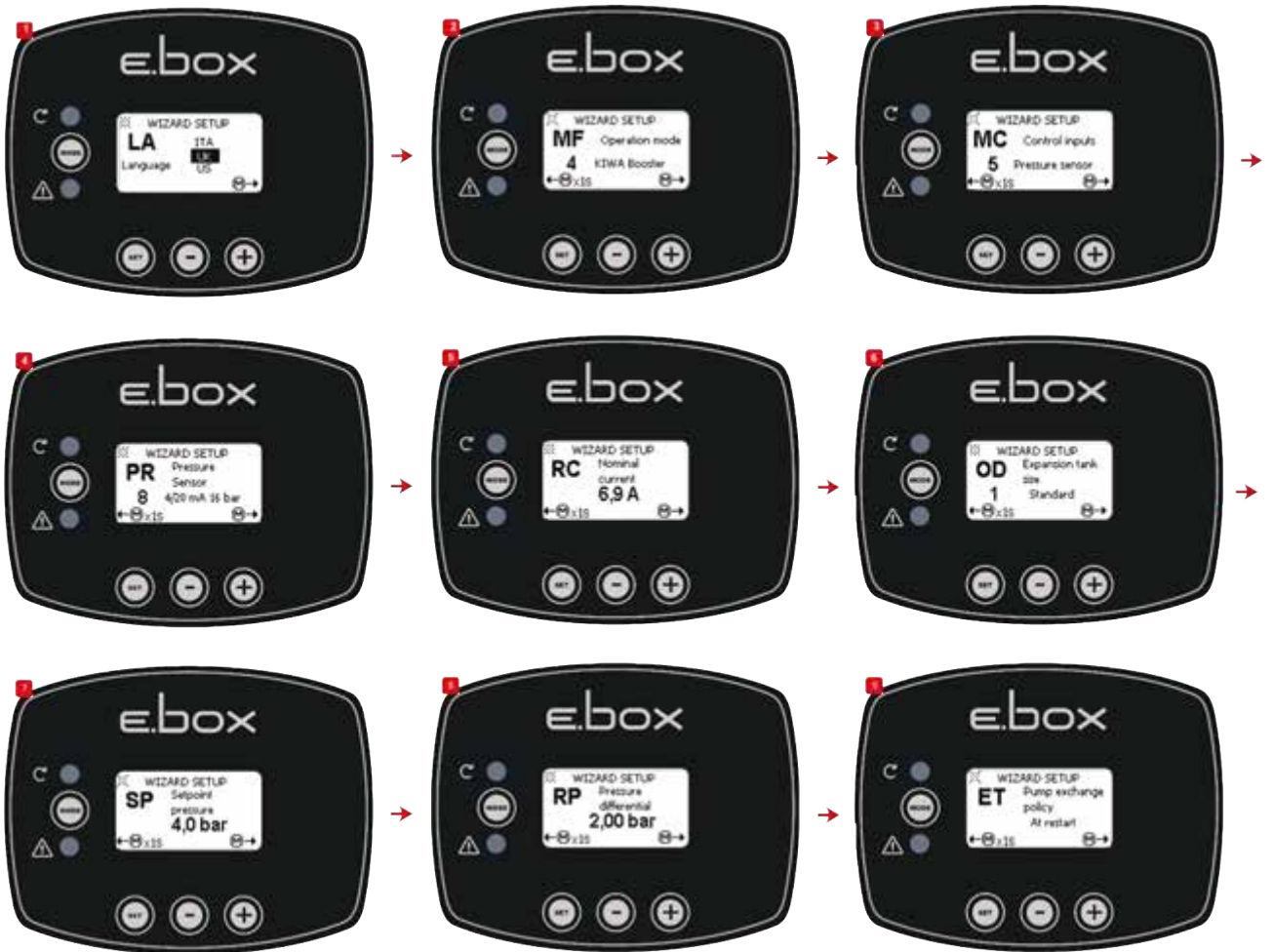
الشكل 48: ضغط KIWA باستخدام مستشعر الضغط
