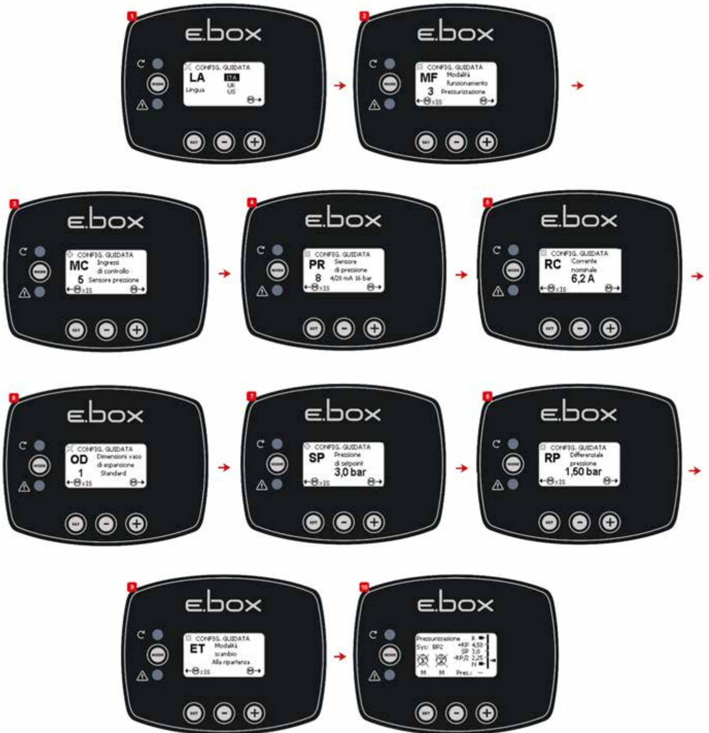
Figure 12 : Configuration avec capteur de pression
