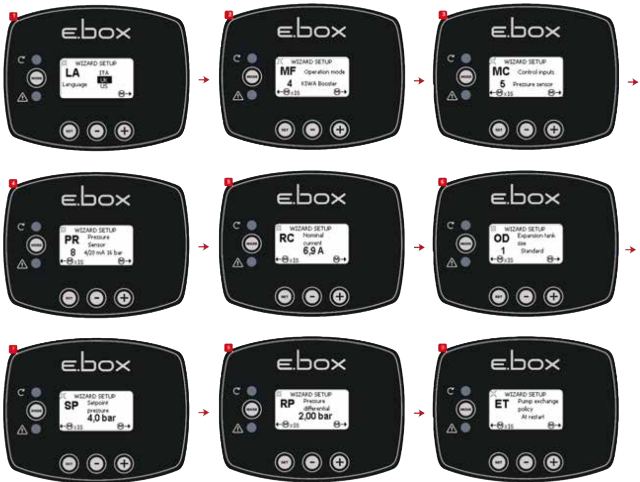
Figure 48 : Pressurisation KIWA avec capteur de pression
