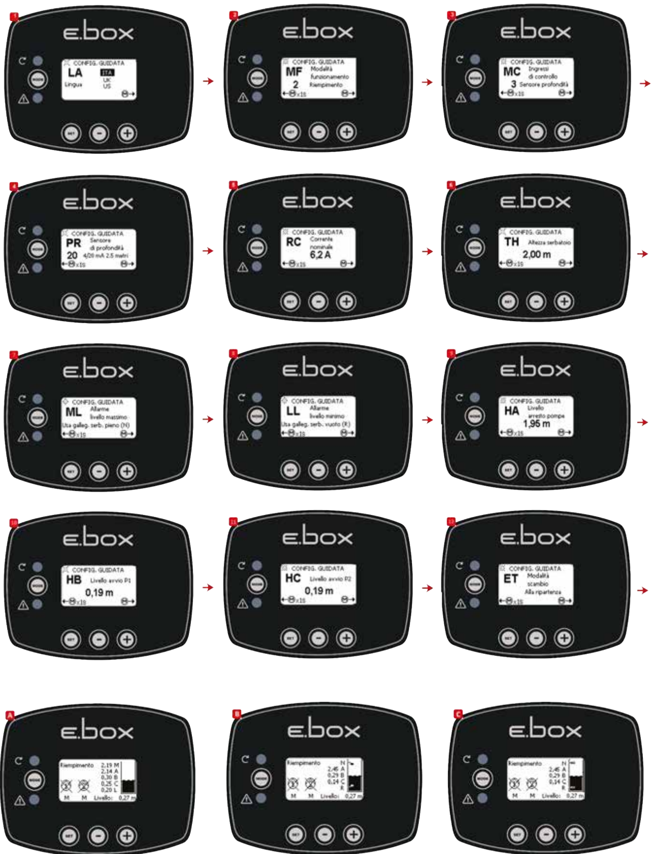
Rysunek 26: Stan układu tylko z czujnikiem głębokości, B z czujnikiem głębokości i pływakami, C z czujnikiem głębokości i sondami poziomymi
