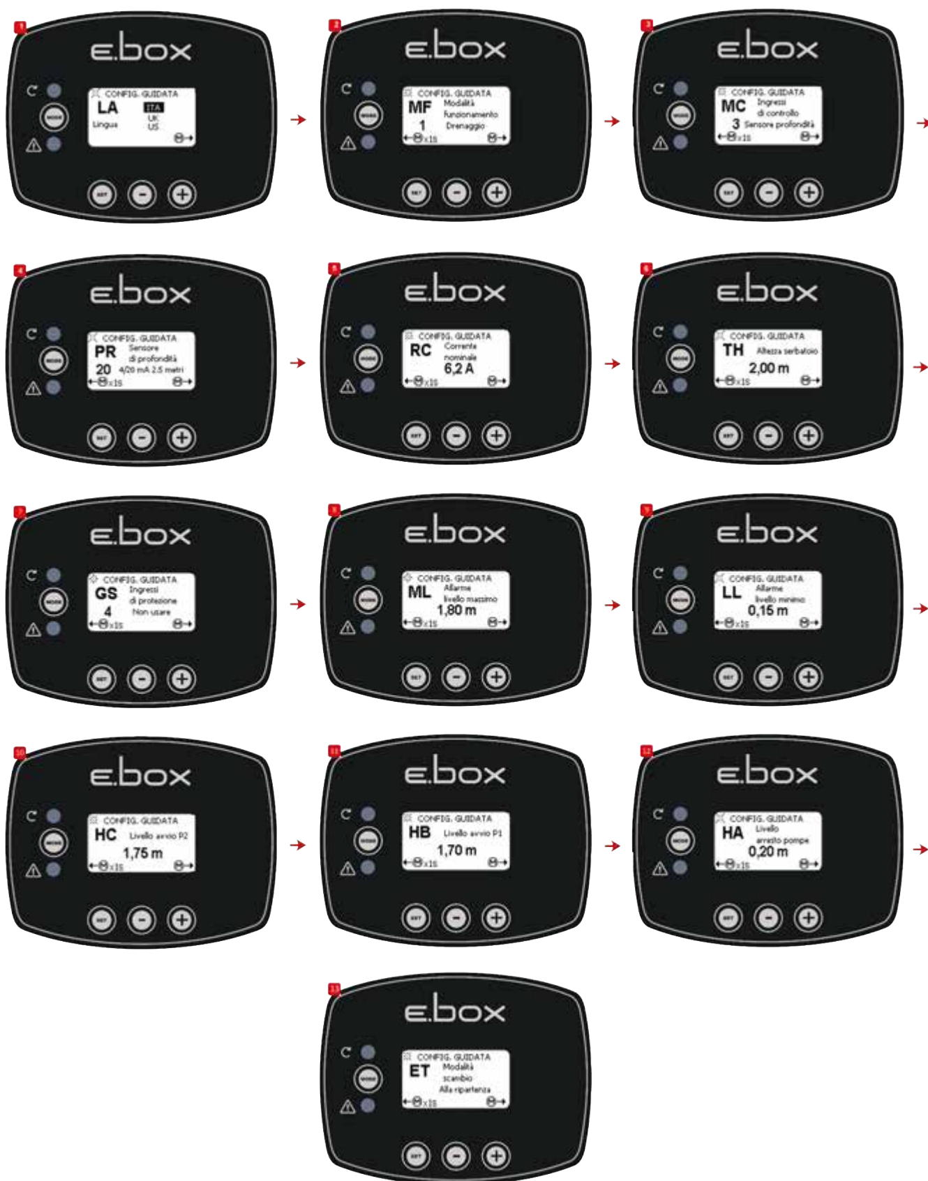
Схема 38: Конфігурація тільки з датчиком глибини
