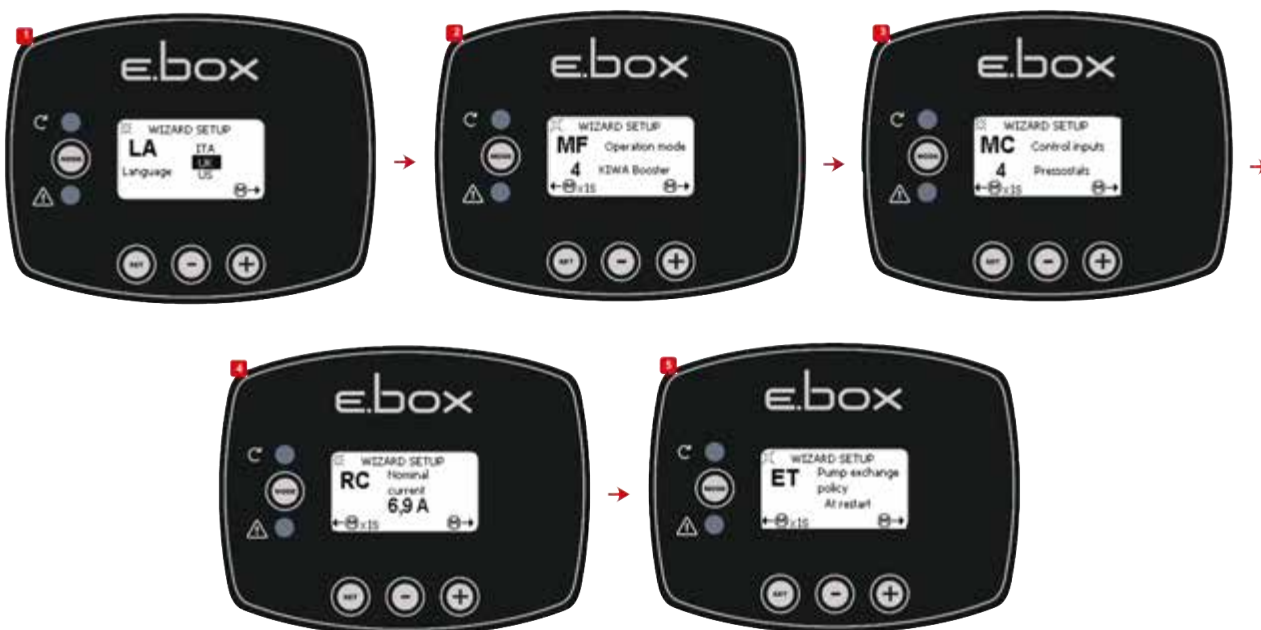
Figura 49: Configurare KIWA cu Presostați
