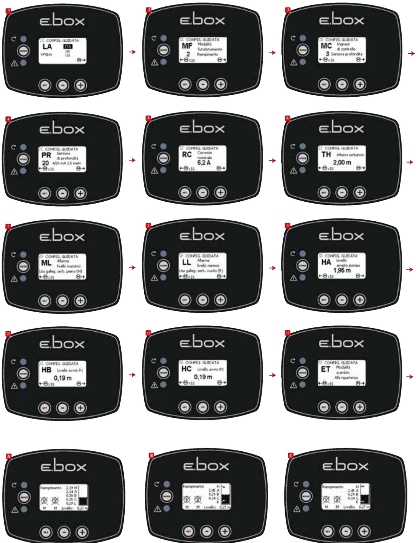
Figure 26 : A État du système est indiqué uniquement avec le capteur de profondeur, B capteur de profondeur et flotteurs, C capteur de profondeur et sondes de niveau
