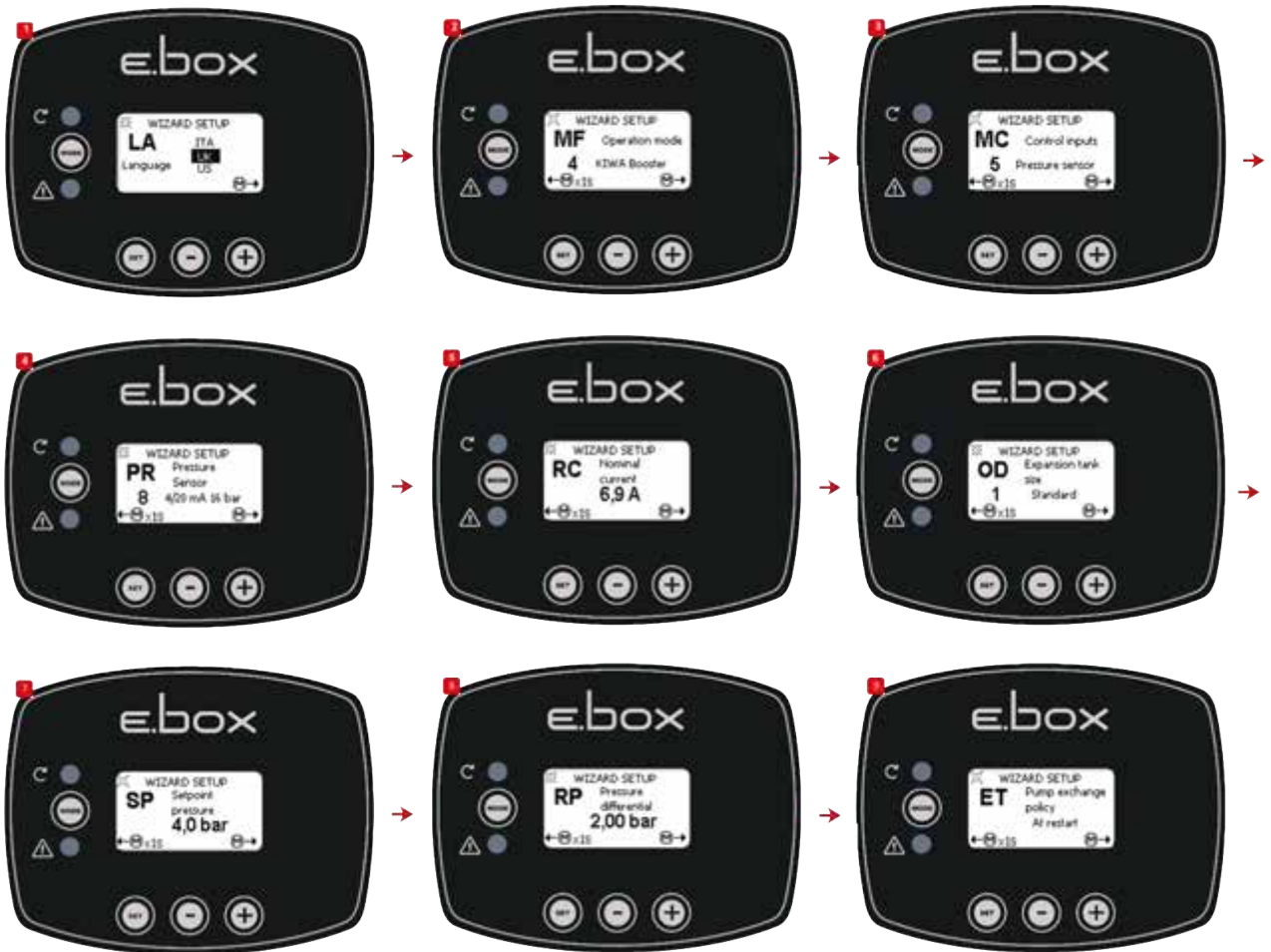
Figura 48: Pressurizzazione KIWA con sensore di pressione
