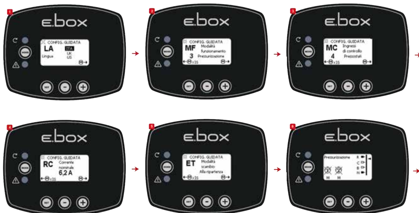
Figura 13: Configurare cu Presostați
