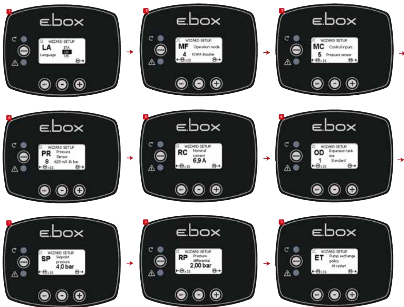
Схема 48: Подпор KIWA с датчиком давления
