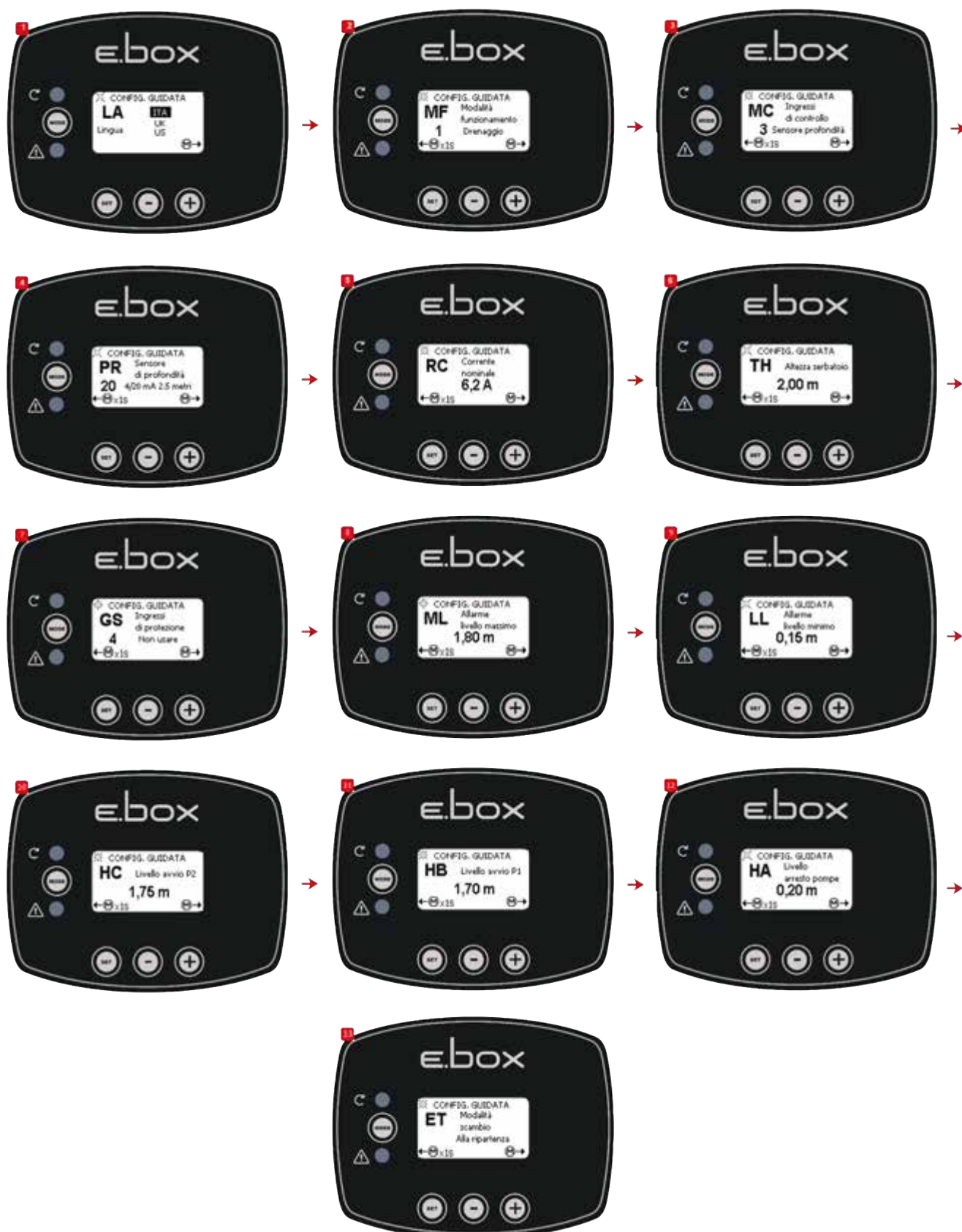
Kuva 38. Määrittys vain yhdellä syvyyssanturilla
