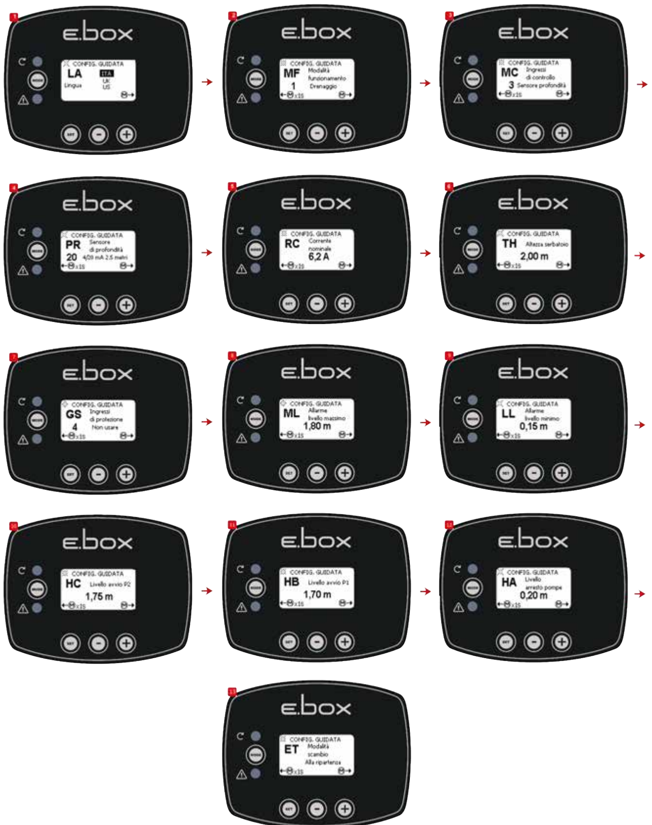
Figure 38 : Configuration avec capteur de profondeur uniquement
