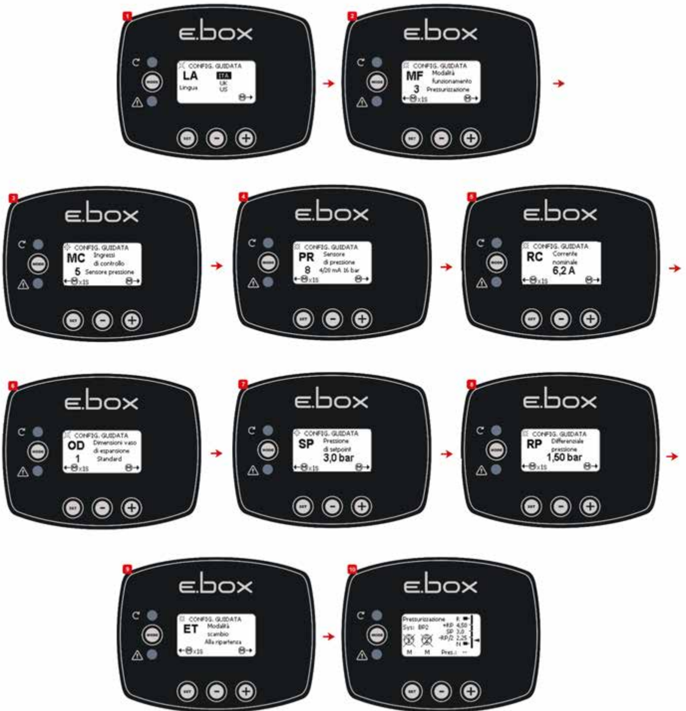
الشكل 12: التهيئة باستخدام مستشعر الضغط
