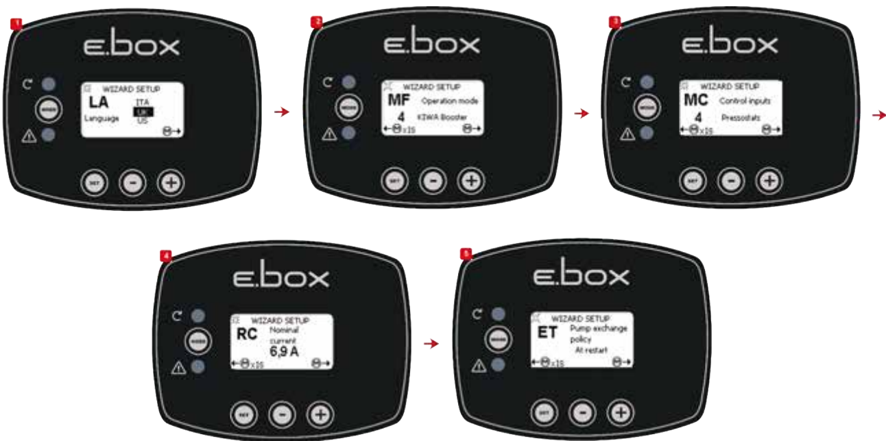
Схема 49: Конфігурація KIWA з реле тиску
