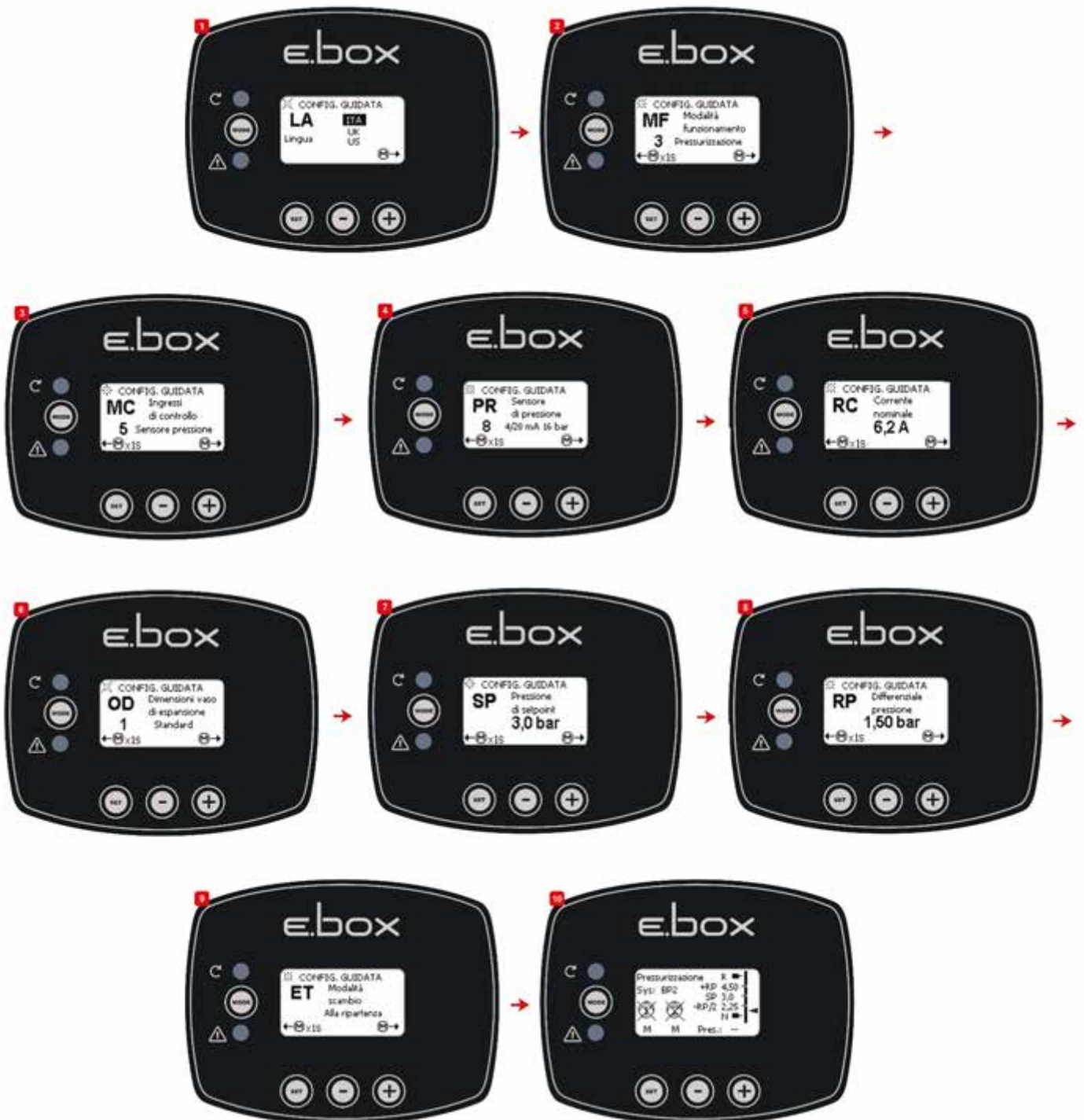
Abbildung 12: Konfiguration mit Drucksensor
