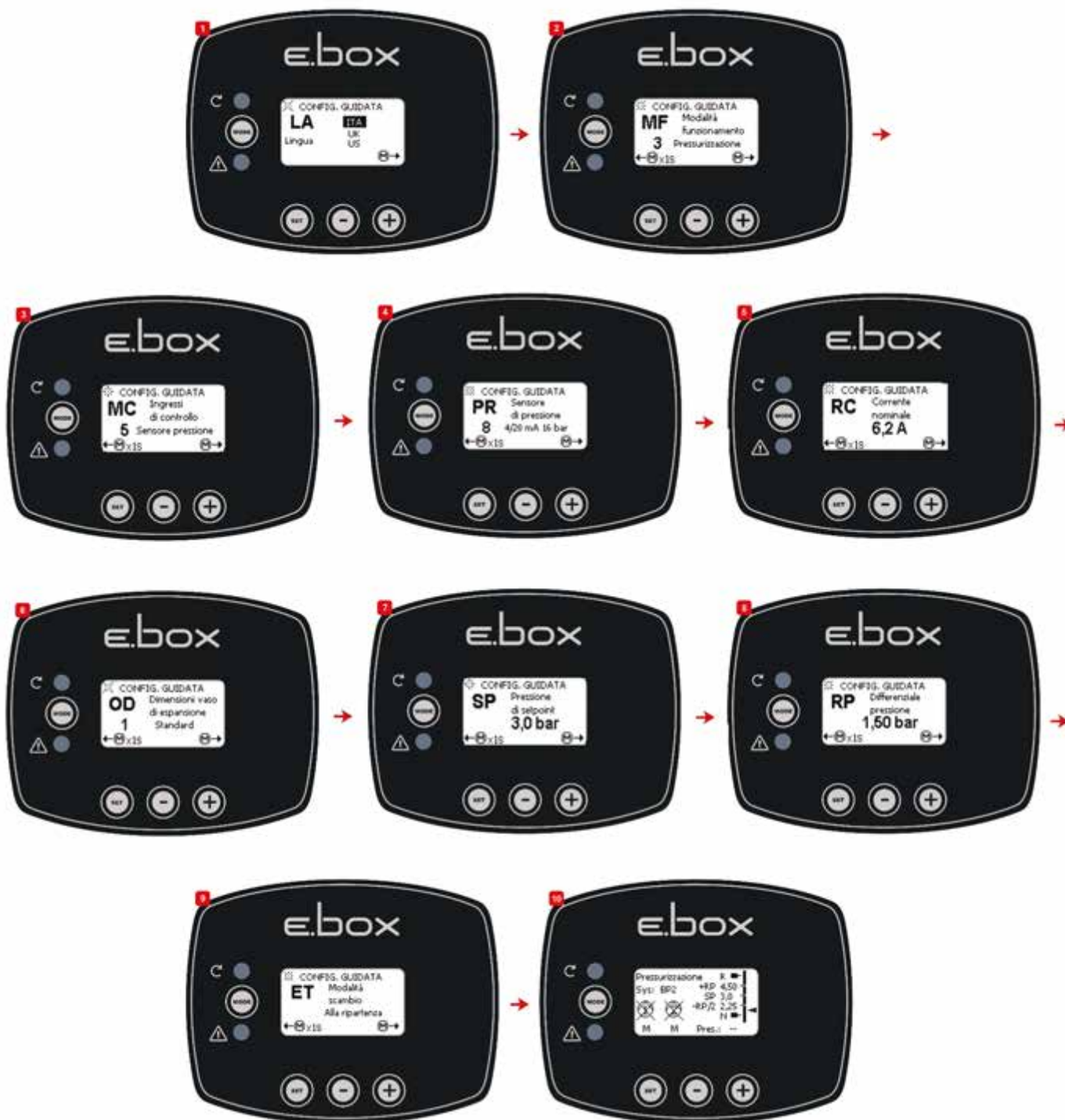
Εικόνα 12: Διαμόρφωση με Αισθητήρα πίεσης
