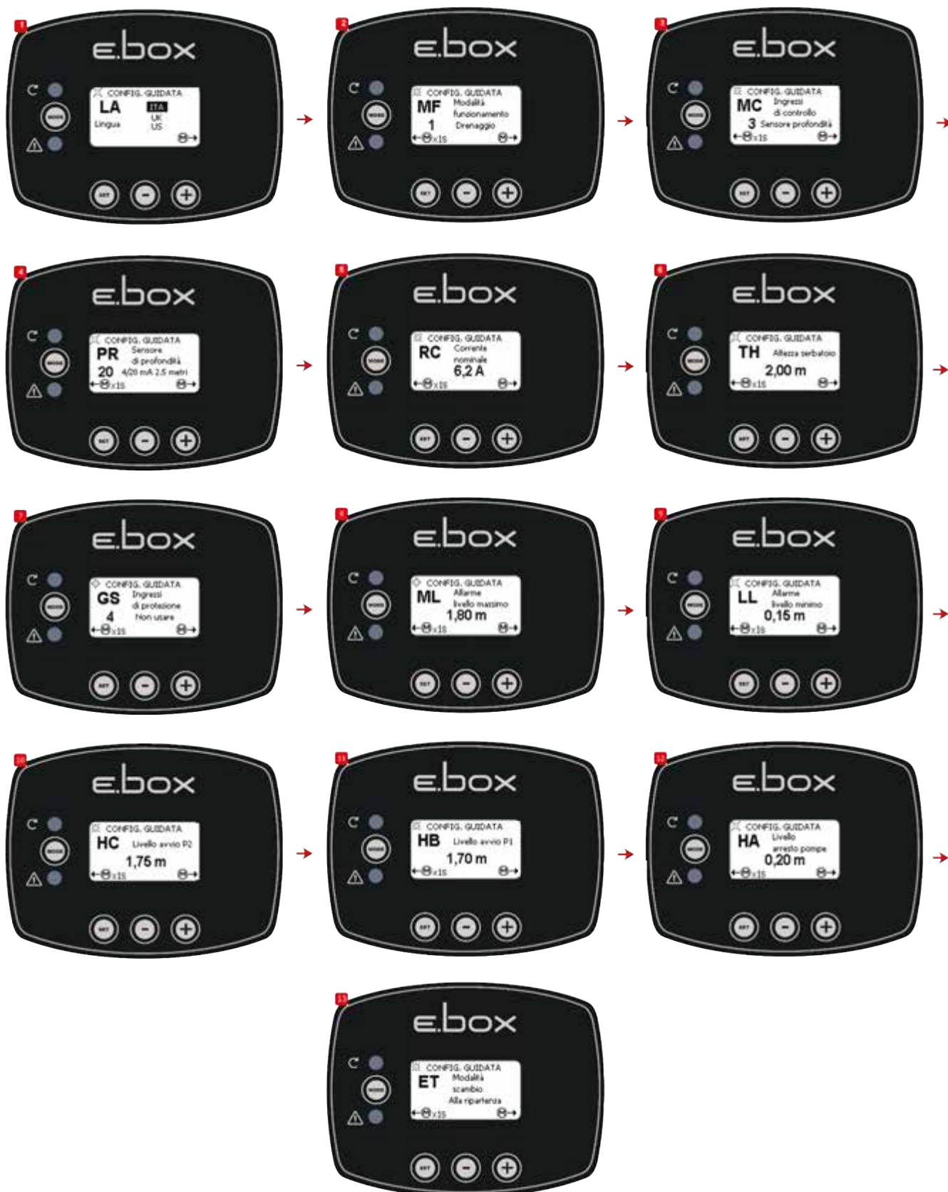
Obrázek 38: Nastavení pouze s hloubkovým čidlem
