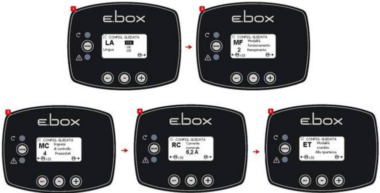
Obrázek 24: Nastavení plnění pomocí plováků nebo hladinových čidel
