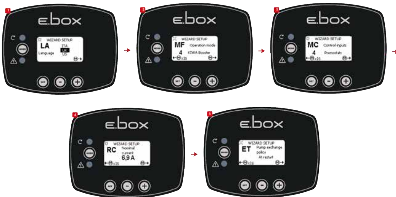
Схема 49: Конфигурация KIWA с реле давления
