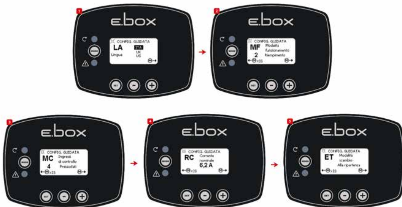
Εικόνα 24: Διαμόρφωση πλήρωσης με πλωτήρες ή αισθητήρια στάθμης
