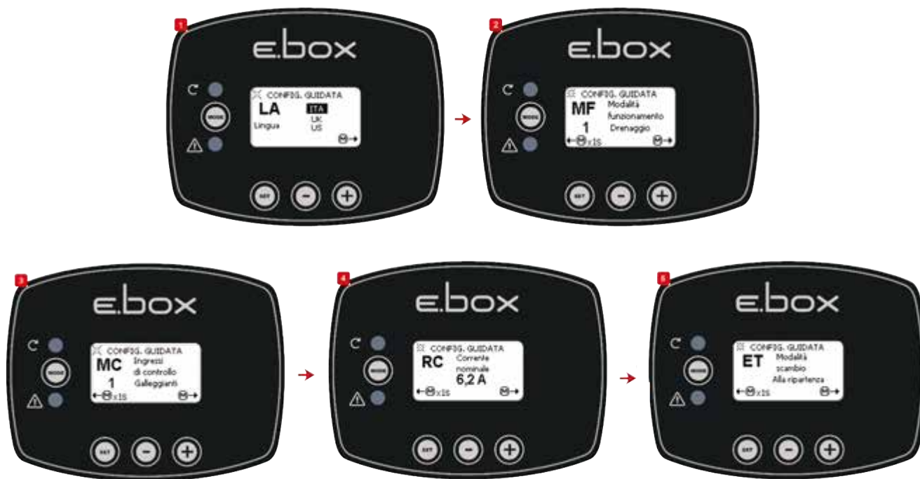
Obrázek 36: Nastavení vypouštění pomocí plováků nebo hladinových čidel
