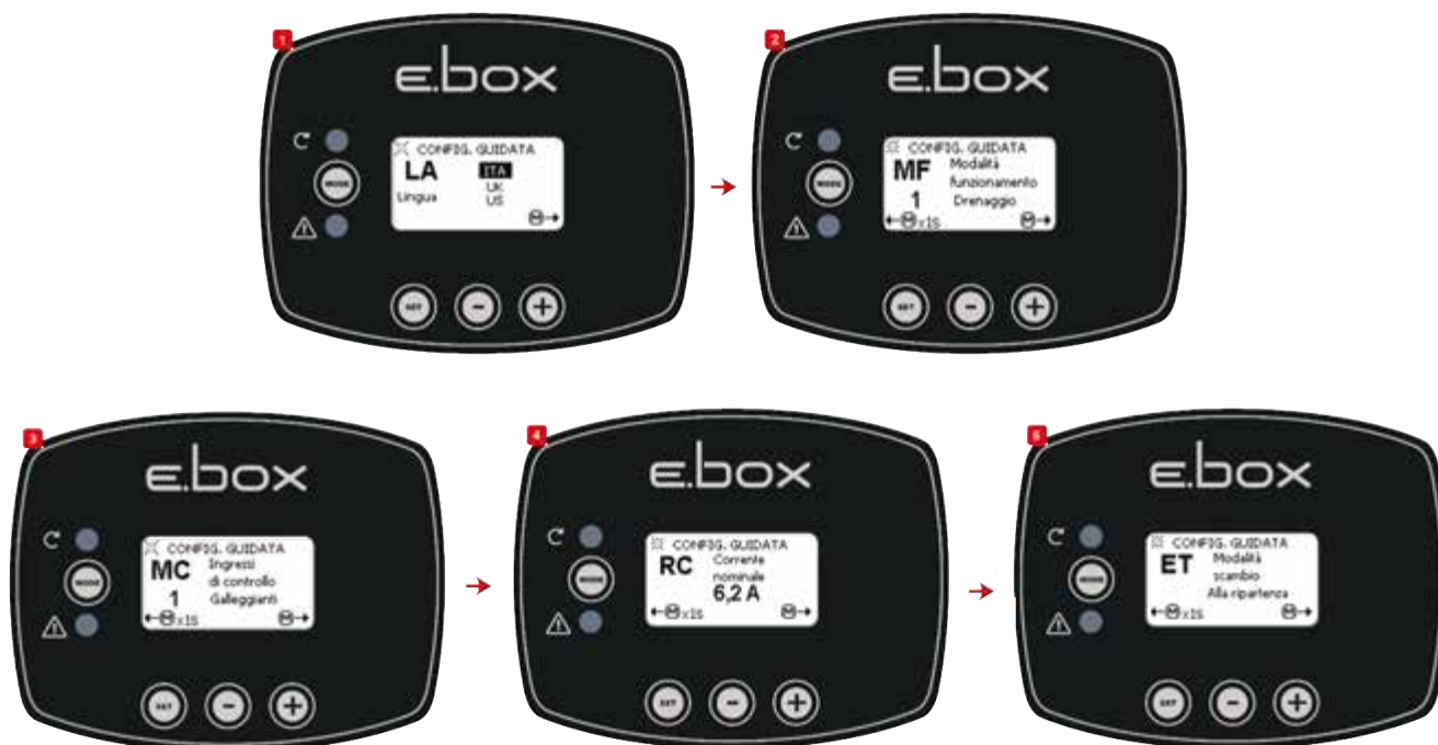
Схема 36: Конфігурація дренажних поплавців або датчиків рівня
