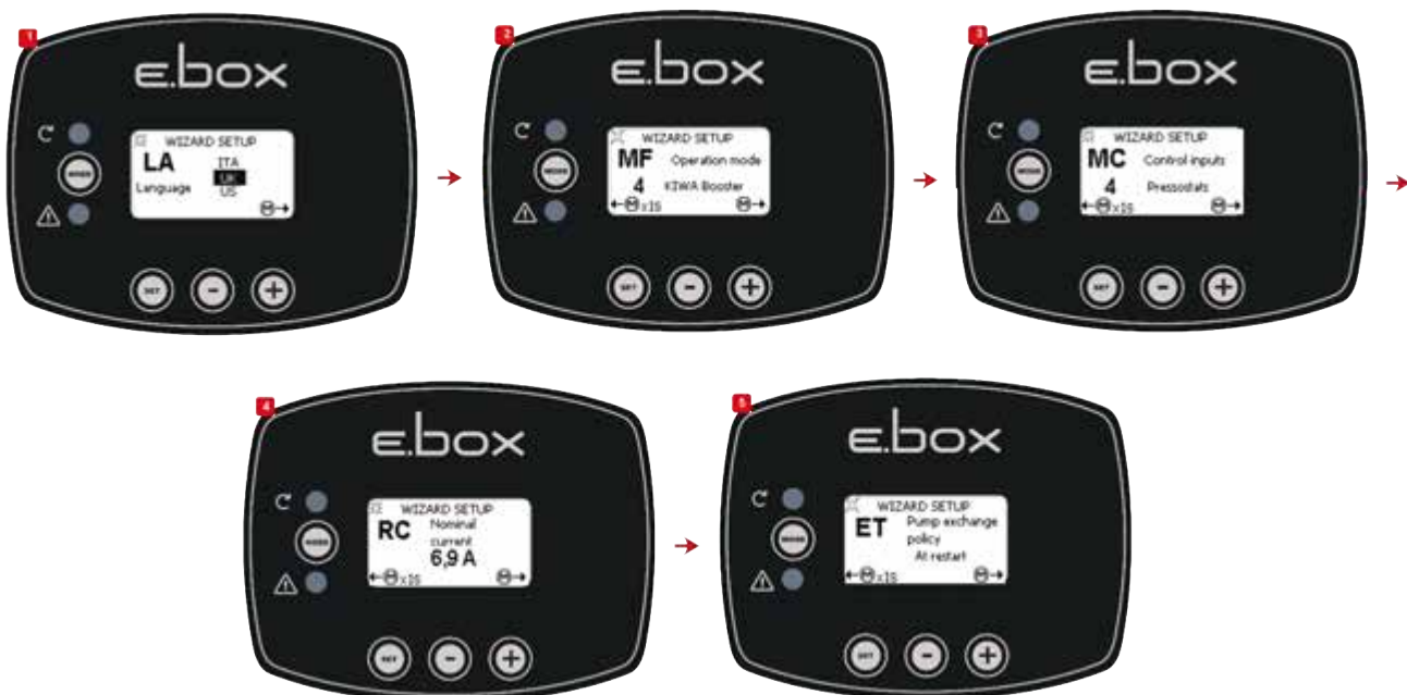
Εικόνα 49: Διαμόρφωση Kiwa με Πιεσοστάτες
