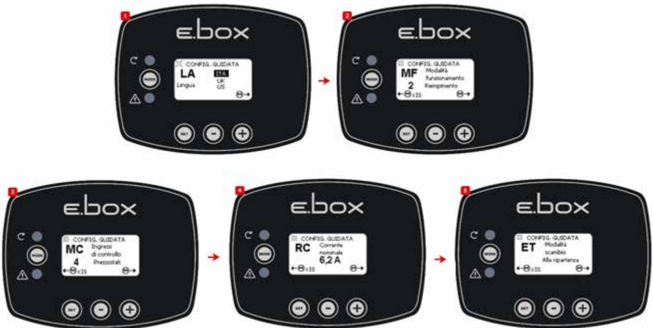
Afbeelding 24: Configuratie Vullen met vlotters of niveauvoelers
