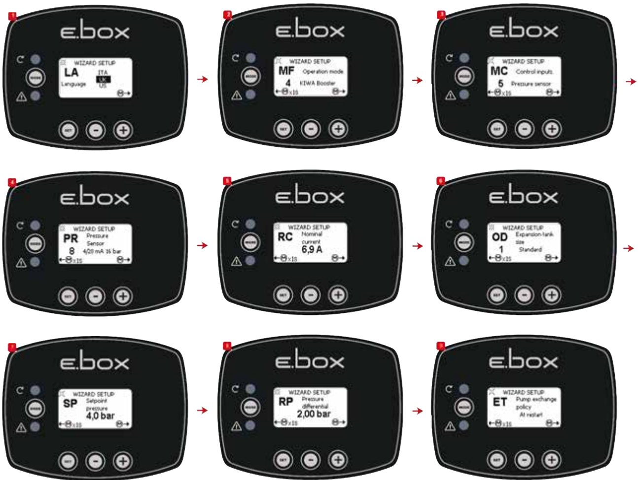
Obrázek 48: KIWA posilování tlaku s tlakovým čidlem
