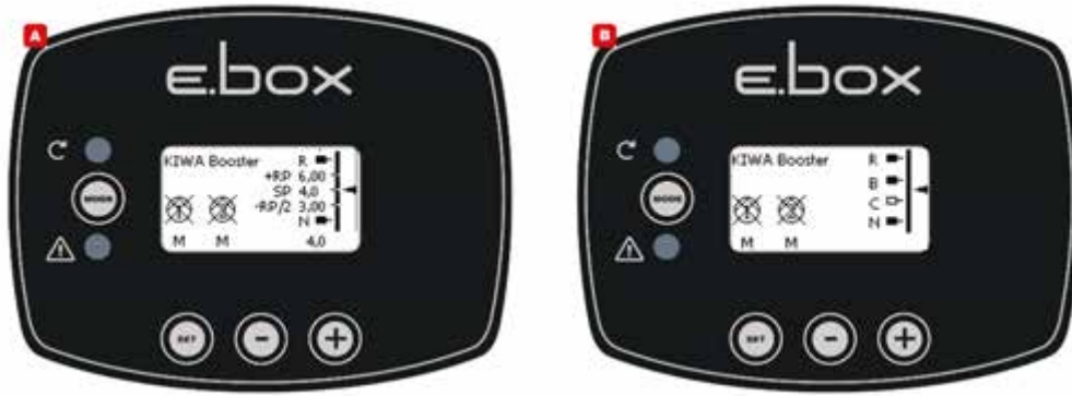
Kuva 50. Järjestelmän tila KIWA-tilassa
