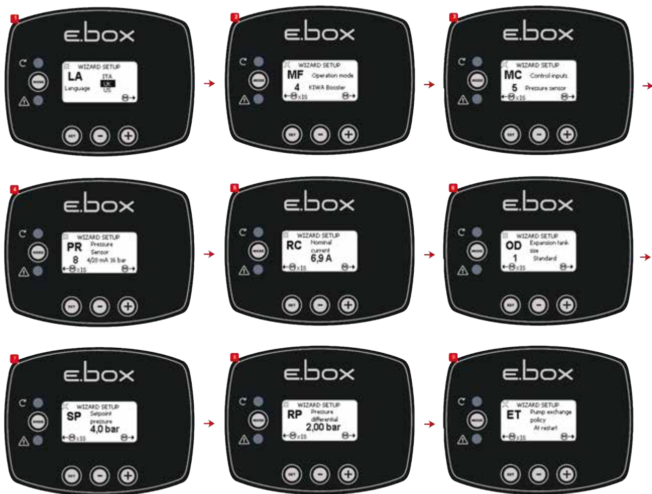
Εικόνα 48: Δημιουργία πίεσης KIWA με αισθητήρα πίεσης
