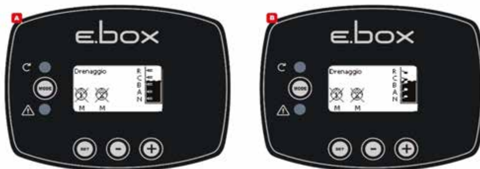
Схема 37: Стан системи в режимі дренажу, А з датчиками рівня. В з поплавцями
