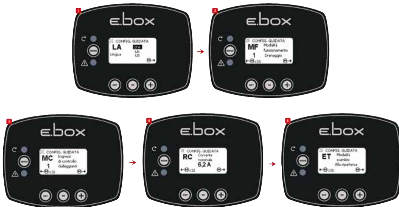
Figura 36: Configurație Drenaj plutitori sau sonde de nivel
