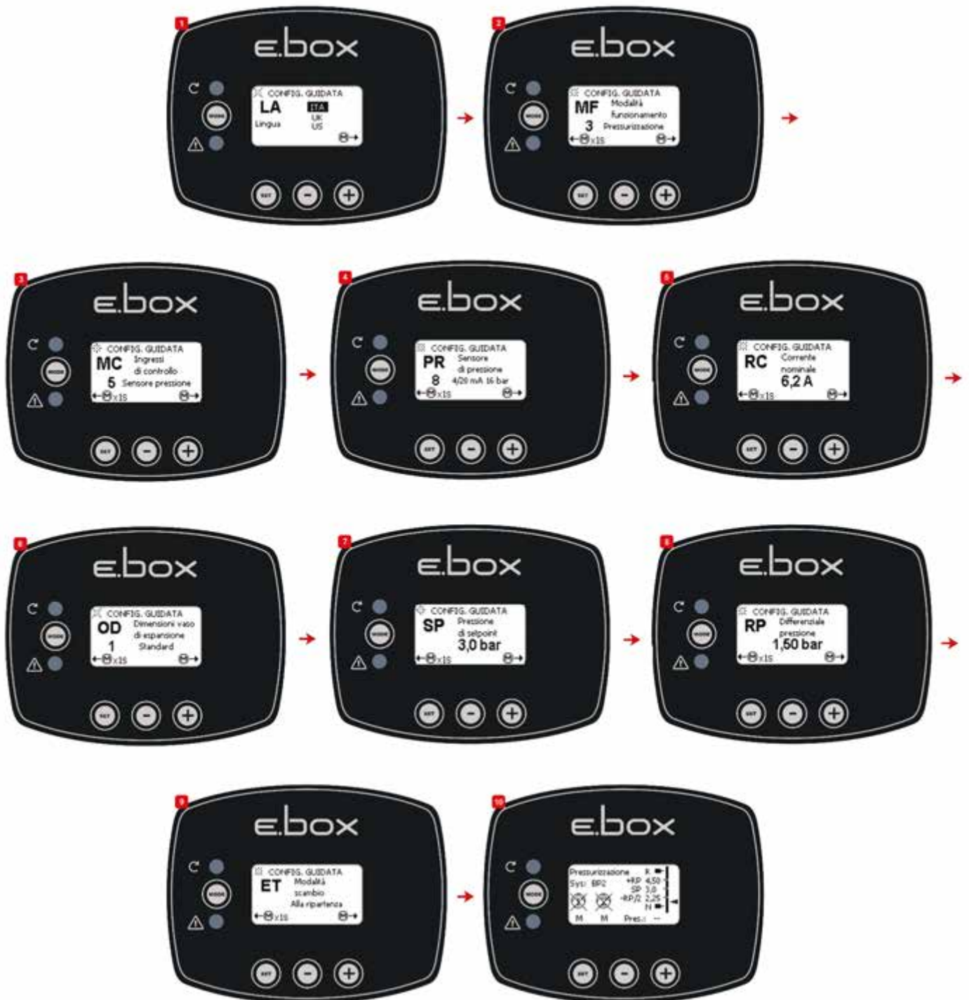
Afbeelding 12: Configuratie met druksensor
