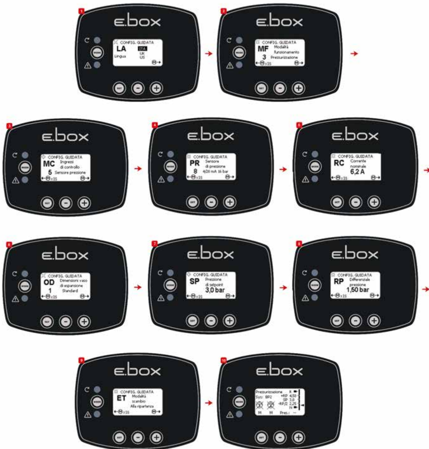
Figura 12: Configurare cu Senzor de presiune
