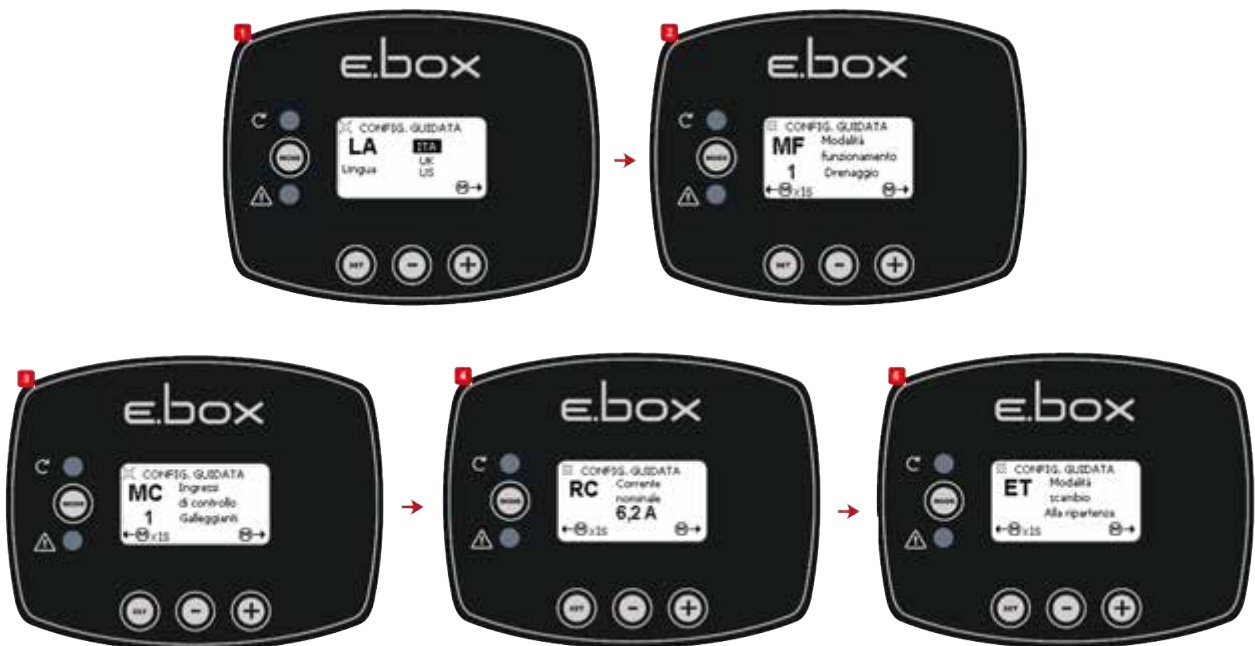
Figura 36: Configurazione Drenaggio galleggianti o sonde di livello
