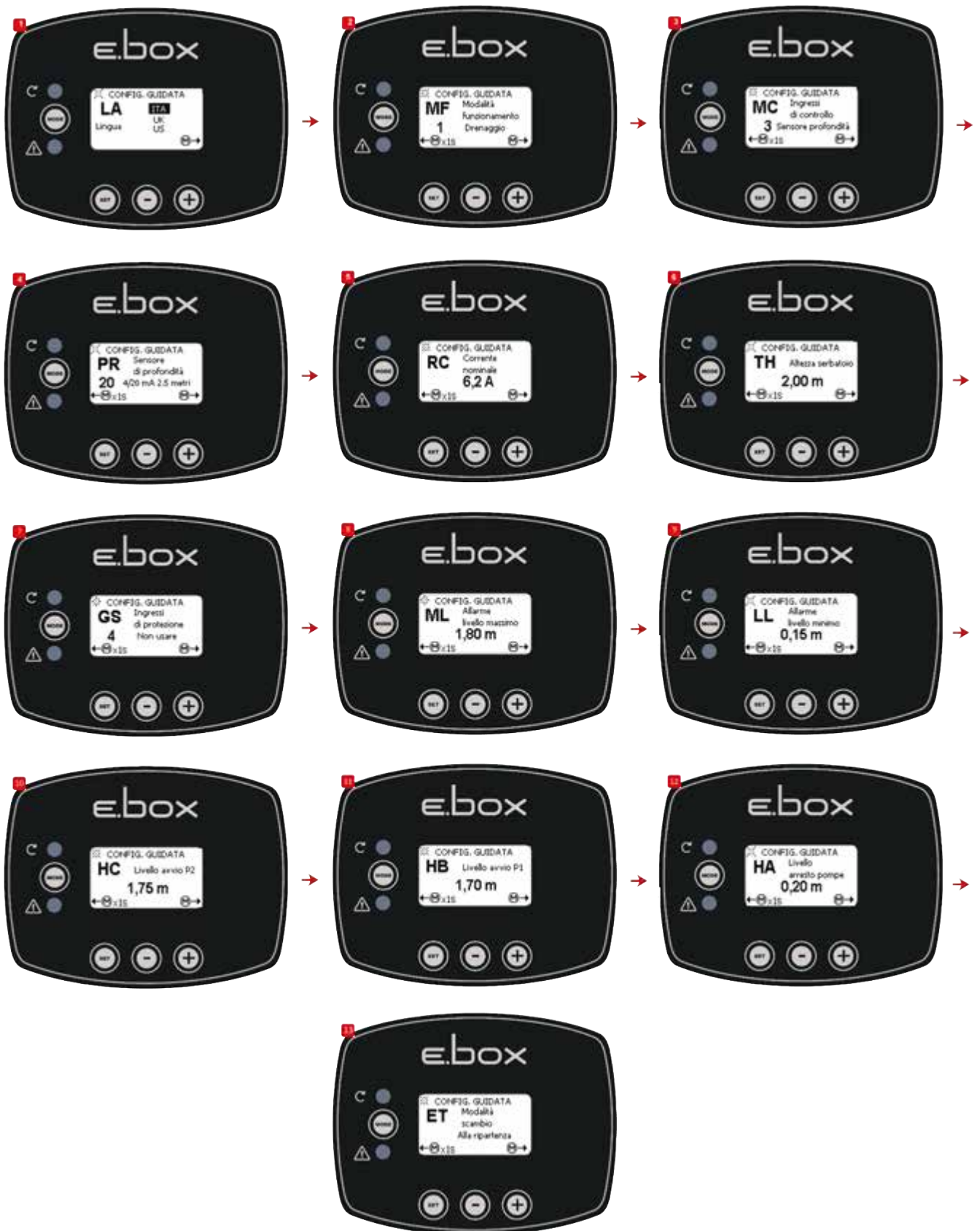
Abbildung 38: Konfiguration mit nur dem Tiefensensor
