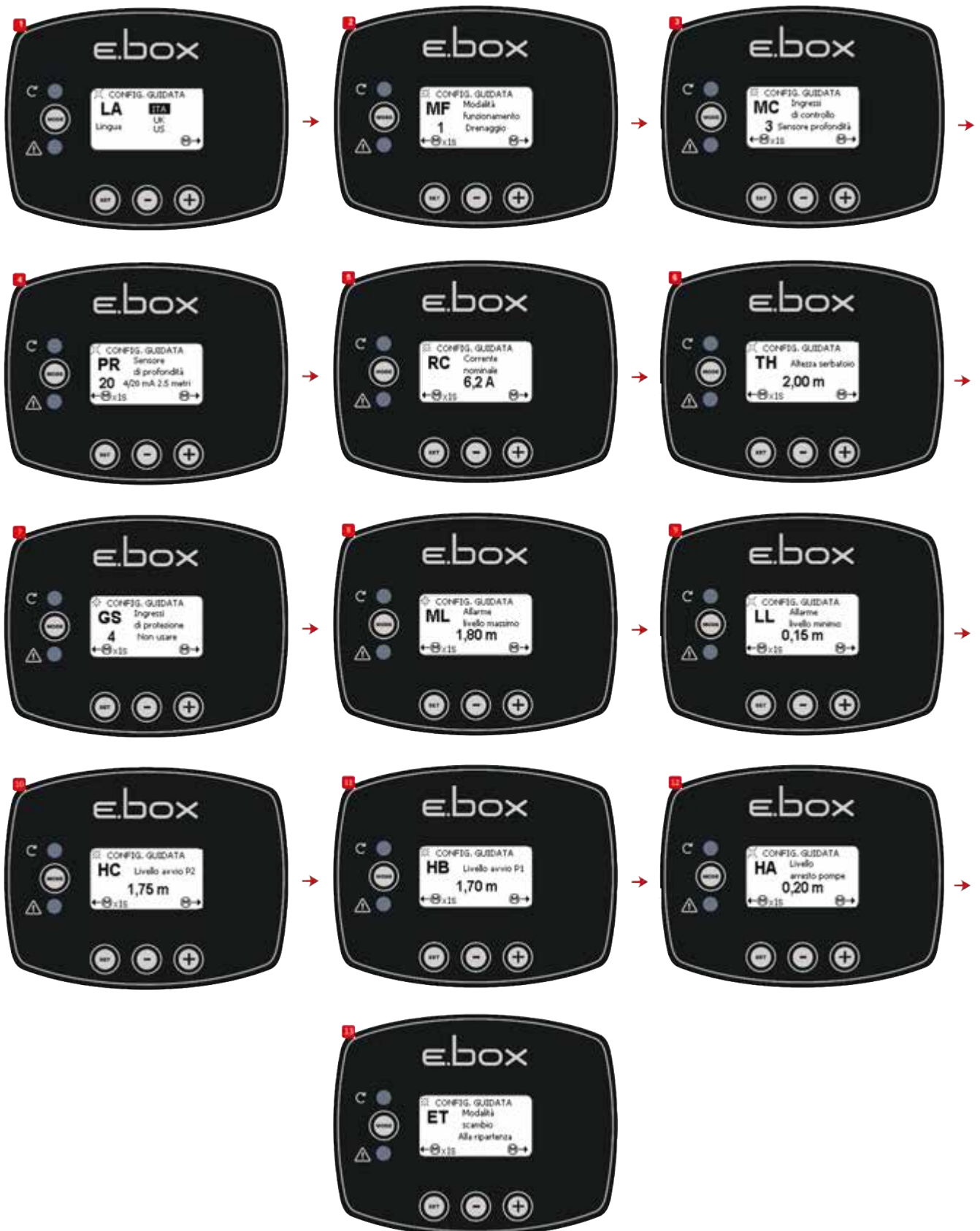
Εικόνα 38: Διαμόρφωση με μόνο αισθητήρα βάθους
