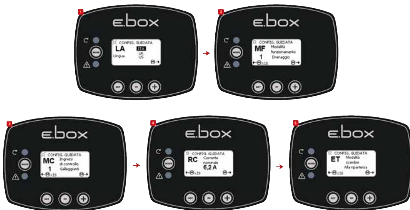
Kuva 36. Tyhjennyksen määrittys uimureilla tai tasoantureilla
