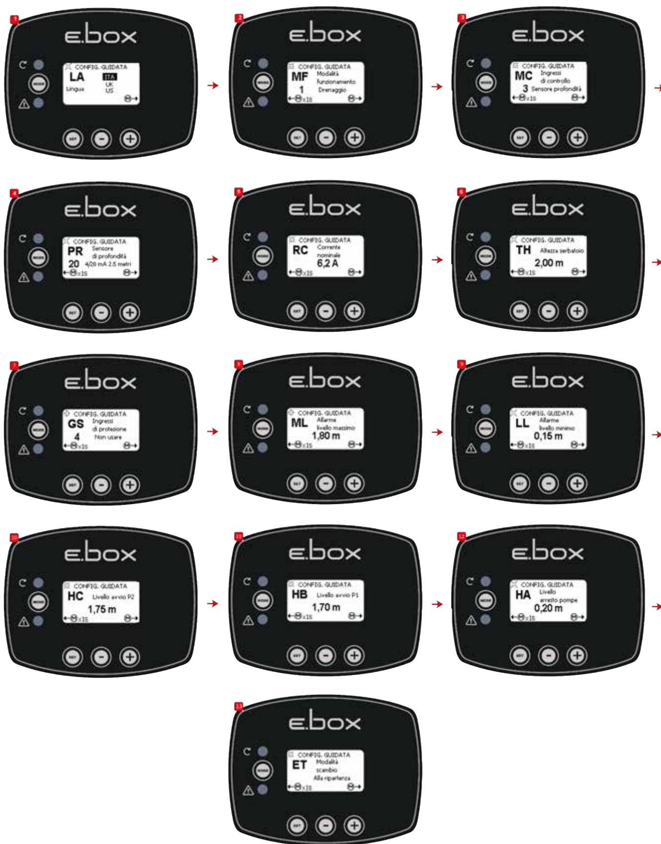
Rysunek 38: Konfiguracja tylko z czujnikiem głębokości
