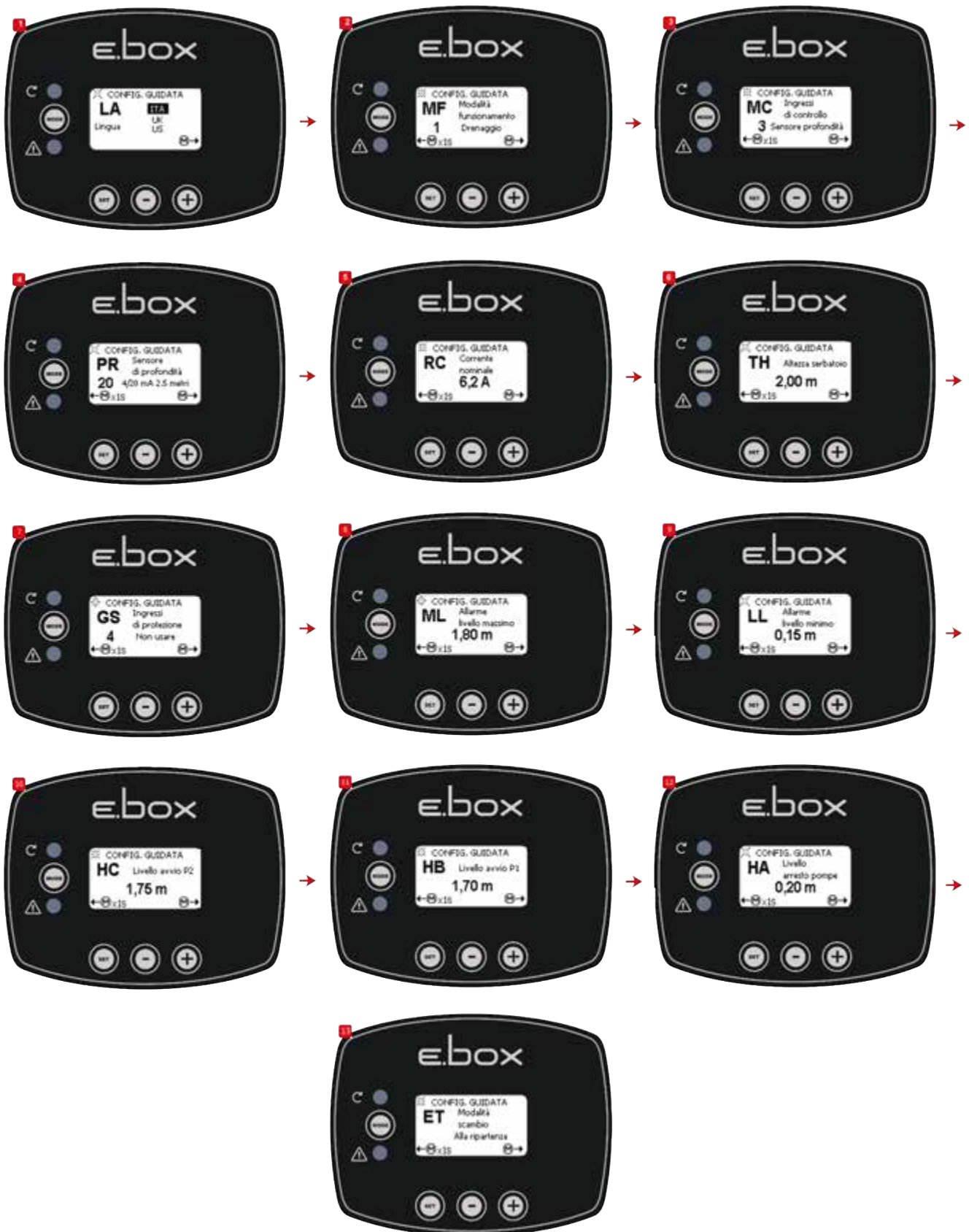
Figura 38: Configuración sólo con sensor de profundidad
