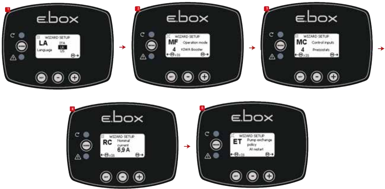
Abbildung 49: Konfiguration KIWA mit Druckwächtern
