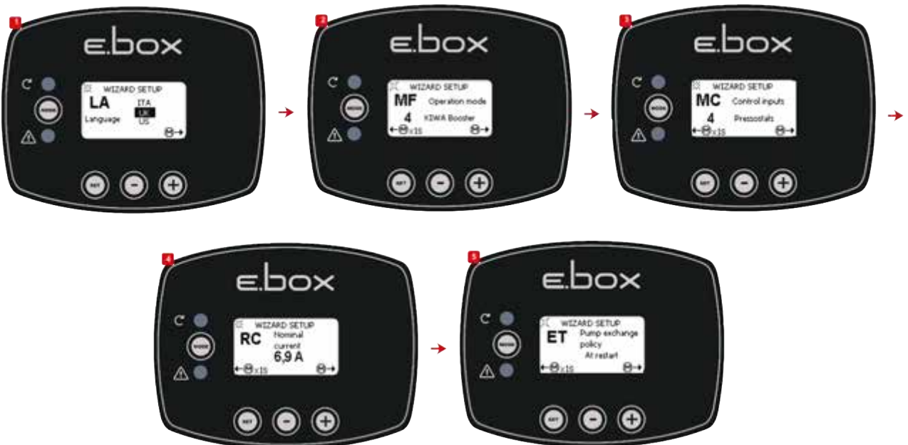
Figura 49: Configurazione Kiwa con Pressostati
