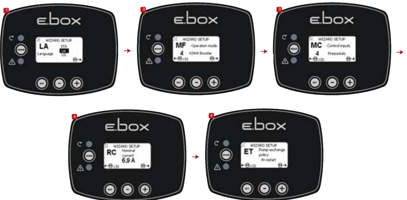
الشكل 49: تهيئة كيوا "Kiwa" باستخدام مفاتيح الضغط
