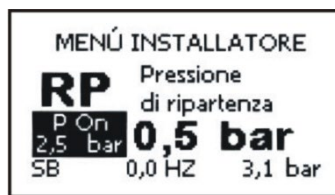
Малюнок 16: Налаштування тиску нового увімкнення
