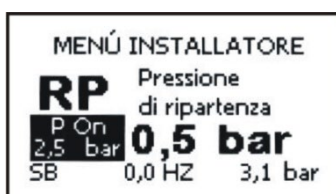
Рисунок 16: Настройка давления нового включения
