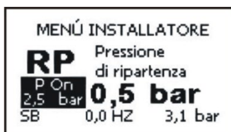
Figura 16: Impostazione della pressione di ripartenza
