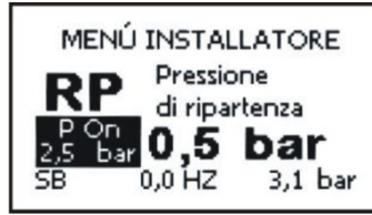
Şekil 16: Yeniden başlatma basıncının ayarlanması
