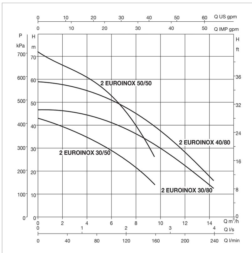
Le curve di prestazione sono basate su valori di viscosità cinematica = 1 mm<sup>2</sup>/s e densità pari a 1000 kg/m<sup>3</sup>. Tolleranza delle curve secondo ISO9906. **Prestazioni complessive riferite a DUE pompe funzionanti contemporaneamente.** Le prestazioni di gruppi con pompe più piccole (es. 2EUROINOX 40/50) si ottengono con la semplice taratura del modulo Active Driver.
